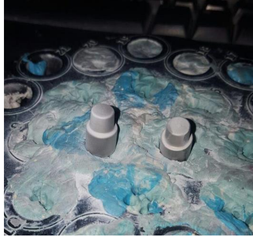
Resim 3: Day spray ile tabaka halinde kaplanan paslanmaz çelik daylar
