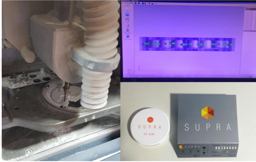
Resim 5: Non-HIP zirkonya blok kullanılarak kuronların üretimi
