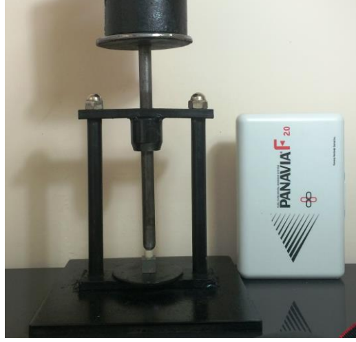
Resim 11: Simantasyon işleminde kullanılan siman ve ağırlık düzeneği
