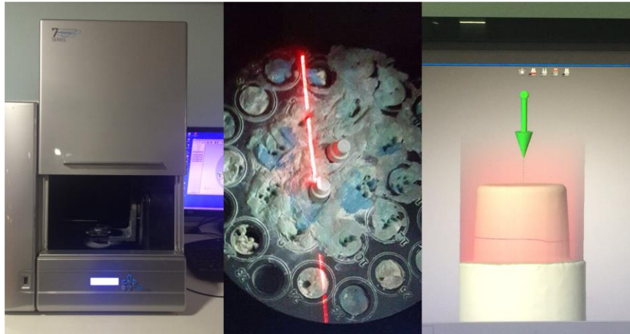
Resim 4: Dwos scanner ile taranıp elde edilen ve dijital ortama aktarılan görüntüler
