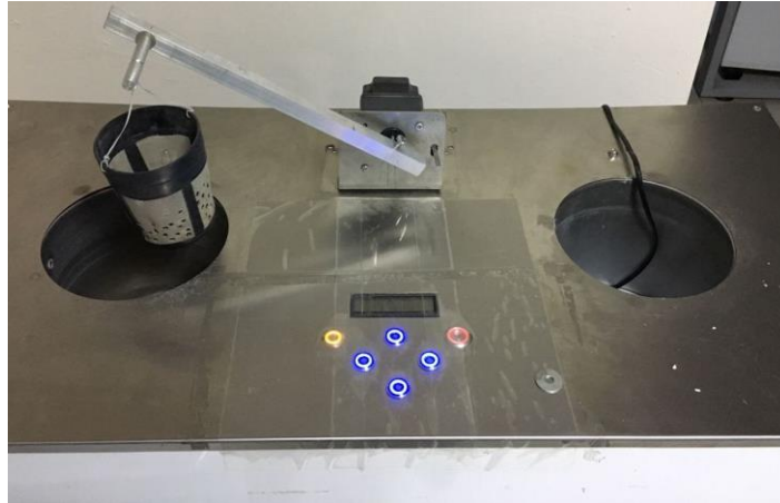
Resim 14: Çalışmada kullanılan termal siklus cihazı
