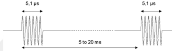
Şekil 2.12 Modülatörün Ürettiği RF Güç Dalgası.
