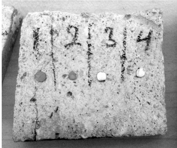
řekil 3.7: Isıl iřlemler iin kullanılan krom magnezit tařı uygulaması.
