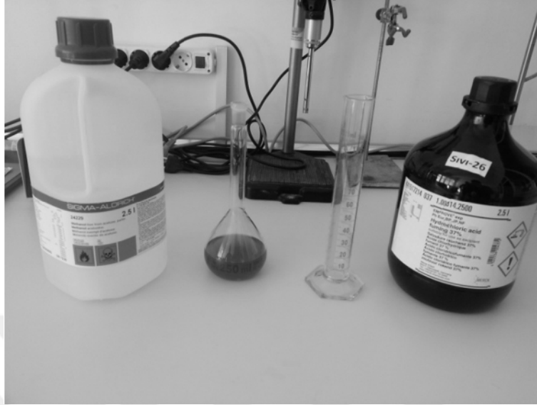
Şekil 3.5: ( \text{FeCl}_3 \cdot 6\text{H}_2\text{O} )-960 ml Metanol ve 200ml HCl dağlama çözeltisi.
