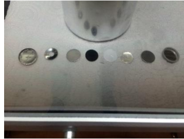
Şekil 3.6: Lityum iyon pil hücresinin montaj parçaları.
