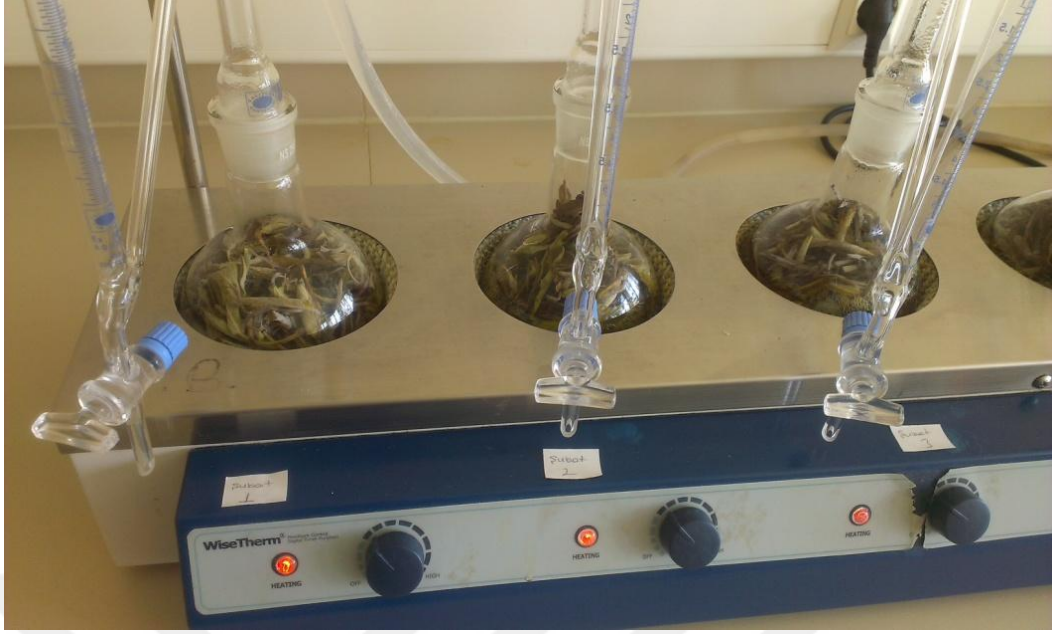
Şekil 3.5. Tıbbi adaçayı yapraklarının Clevenger cihazında damıtılması
