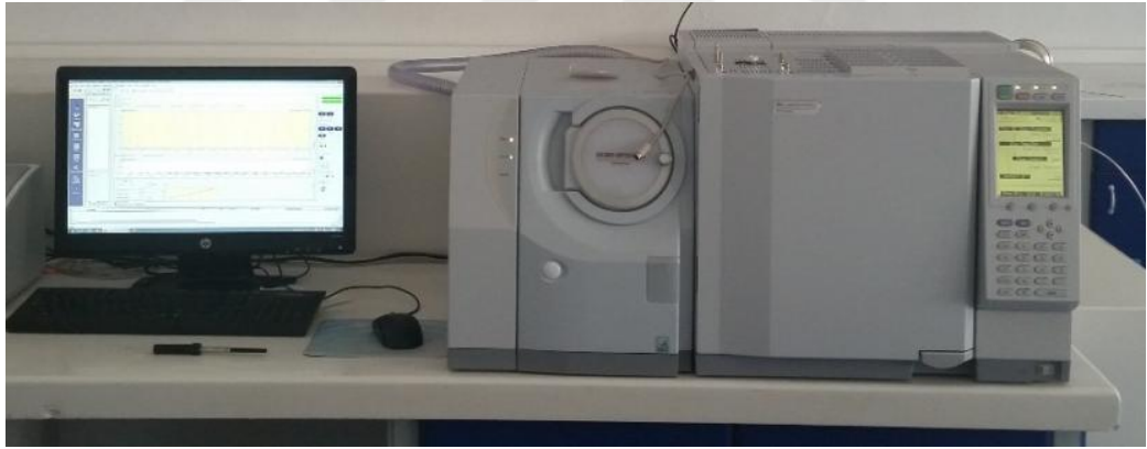
Şekil 3.6. GC-MS cihazında uçucu yağ bileşenlerinin belirlenmesi
