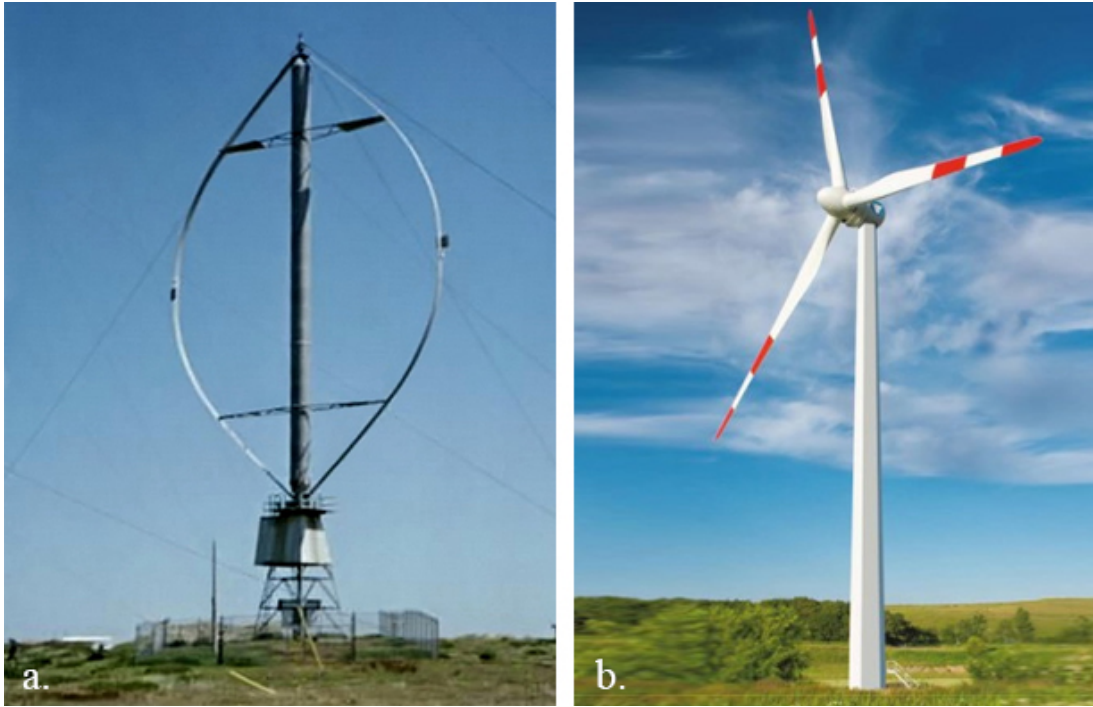
Şekil 5.11 : Düşey (a) ve yatay (b) eksenli rüzgâr türbini örnekleri (Url-20), (Url-21)
