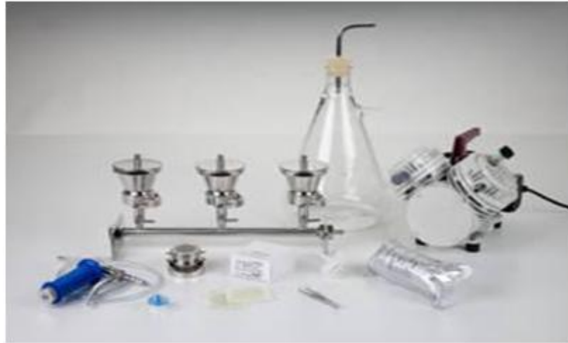
Şekil 3.2. Membran Filtrasyon Düzeneği Ekipmanları (Sartorius)
