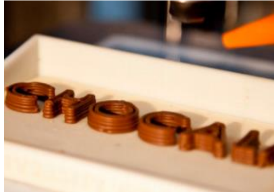
řekil 1.65 : Çikolata basan üç boyutlu yazıcı
