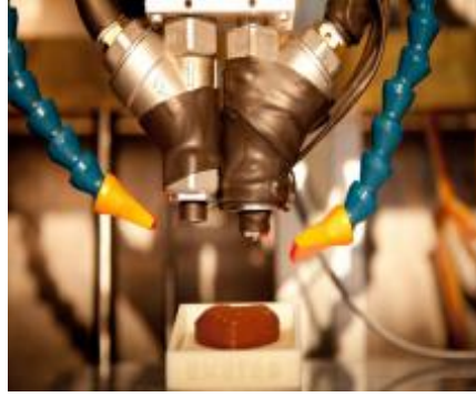
Şekil 1.66 : Çift nozullu üç boyutlu yazıcı
