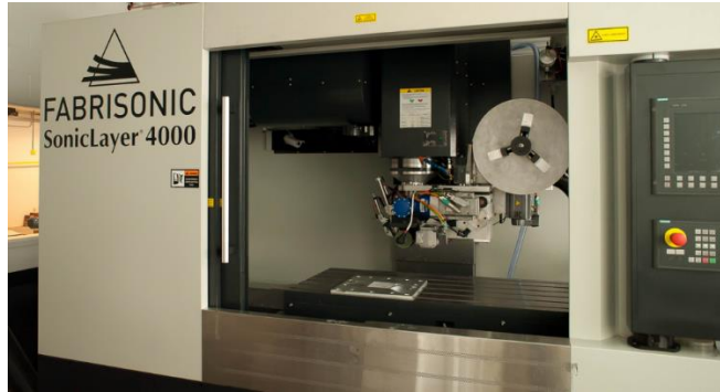
Şekil 1.100 : SonicLayer 400, UAM teknolojisiyle çalışan üç boyutlu yazıcı
