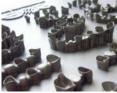
Şekil 1.69 : Katmanlı üretim ile üretilmiş kopinger
