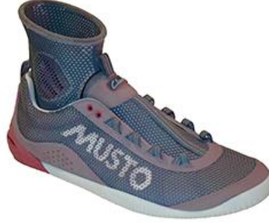
Şekil 1.90 : 3D Systems, Projet 4500 ile üretilen ayakkabı modeli
