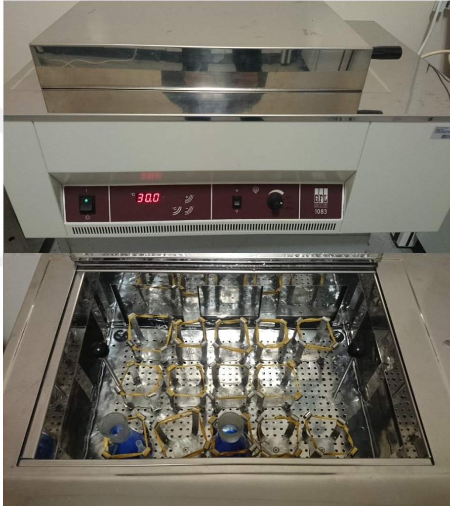
Şekil 5. 1 Denemelerde kullanılan sabit sıcaklıklı, çalkalamalı su banyosu
