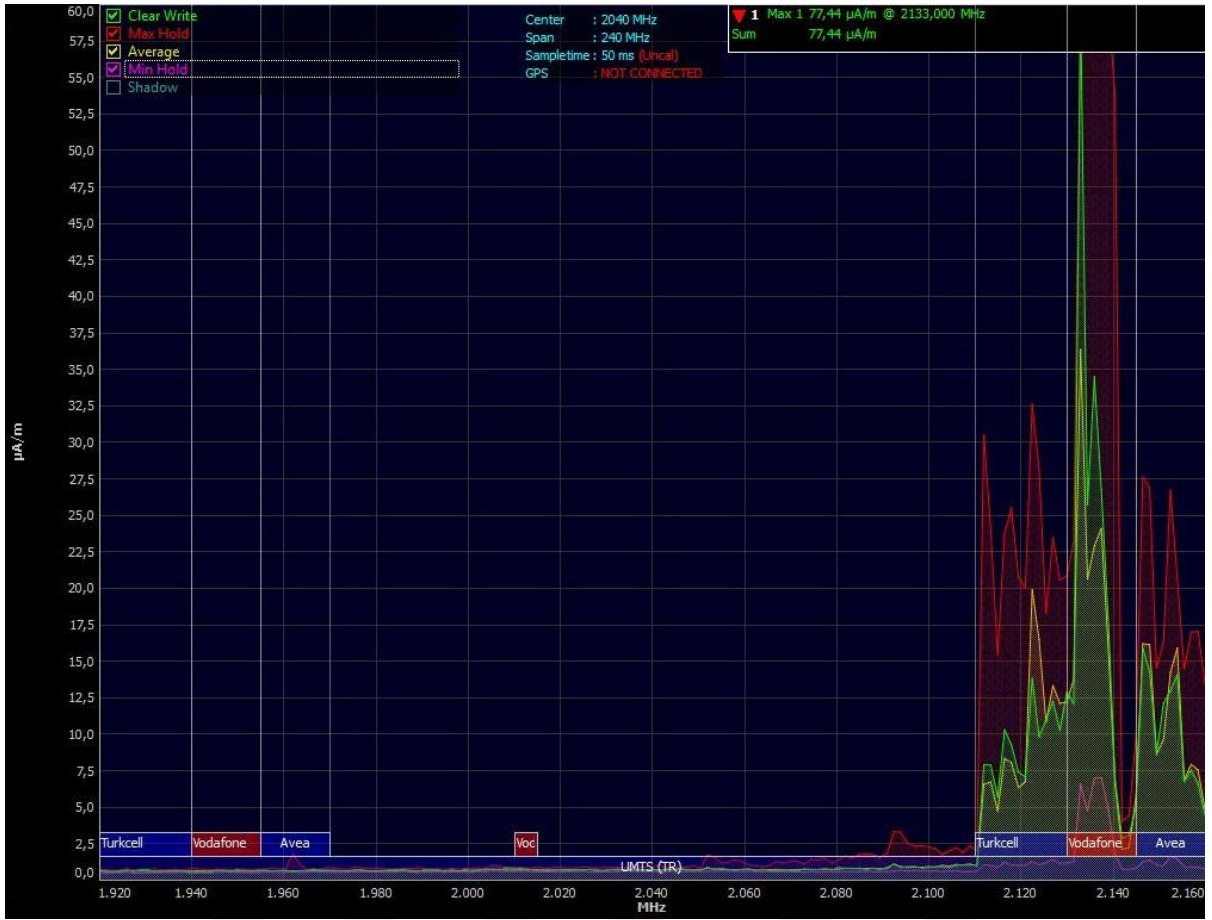
Şekil 3.11. Aaronia Spectran HF-60105 V4 Taşınabilir Spektrum Analizörü ile 2100 MHz (UMTS) frekansında alınan örnek manyetik alan spektrumu.
