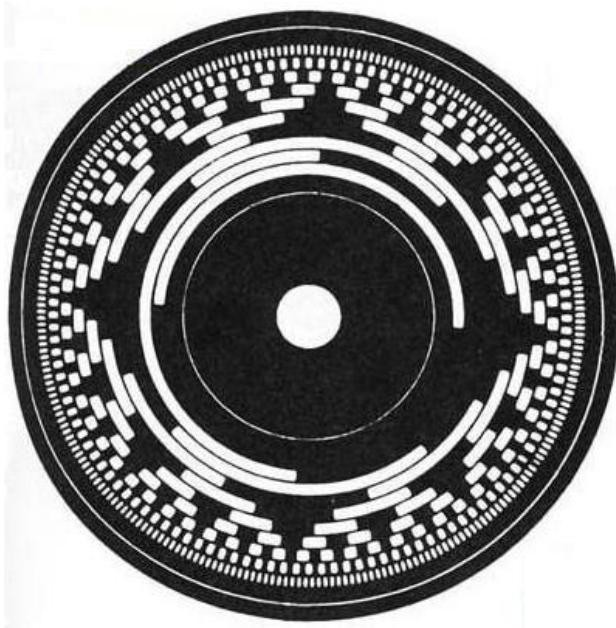
Şekil 2.27. Kesin değerli açı kodlayıcı
