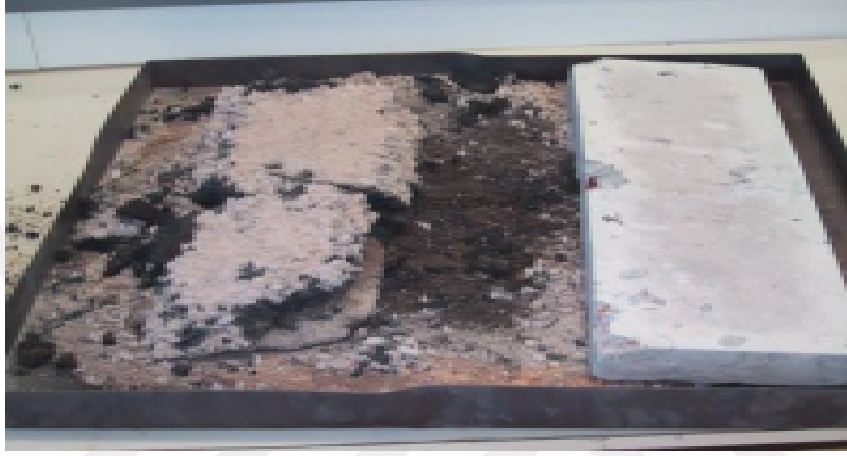
Şekil 3.1: Asfalt ve beton numunelerinin 750°C'ye ısıtıldıktan sonraki halleri (Noumowe, A.,2003).
