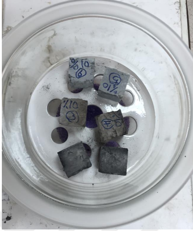
Şekil 3.9. Numunenin oda sıcaklığına kadar soğutulmasında kullanılan desikatör
