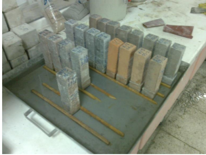
Şekil 3.13. Numuneler üzerinde kılcal su emme deneyinin yapılışı
