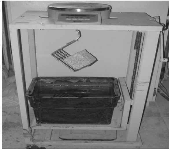
Şekil 3.14. Beton numune hacminin su ile yer değiştirme metoduyla tayini için tipik kefe düzeneği
