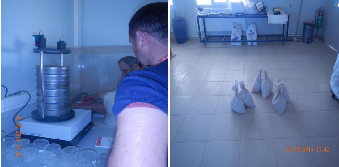
Şekil 3.30. Arazi çalışmasında alınan numuneler ve eleme işlemi
