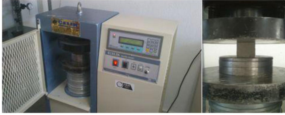
Şekil 3.33. Tek eksenli basınç dayanımı düzeneği
