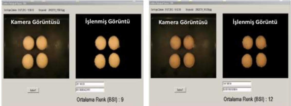
Şekil 4. 19 Fırın içinden gerçek zamanlı renk ölçümü
