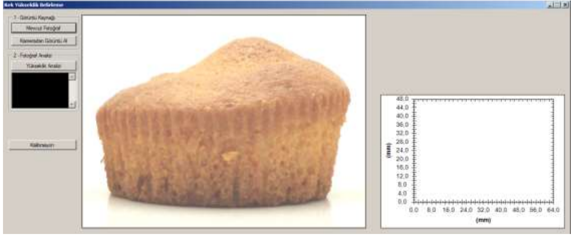
Şekil 4. 6 Görüntü işleme yöntemi ile kek yüksekliğinin belirlenmesi
