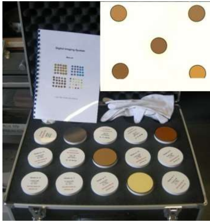
Şekil 4. 18 BSI renk ölçüm cihazı kalibrasyon plakaları
