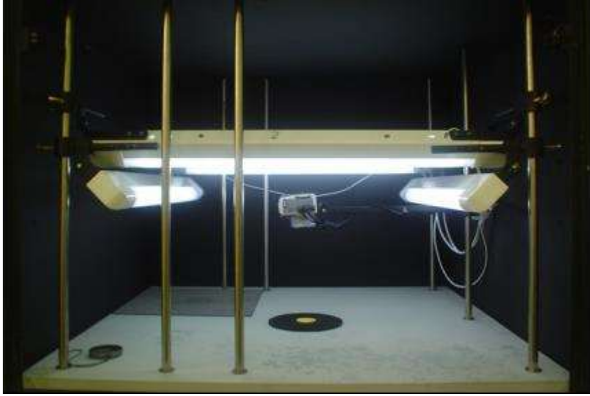
Şekil 3. 6 Patates cipsi görüntü alma düzeneği [12]
