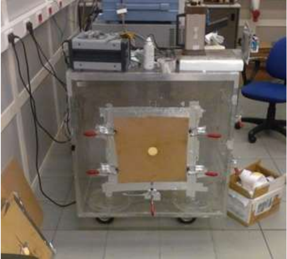
Şekil 4. 23 Kek numunesinin rüzgar tüneli üzerindeki yerleşimi
