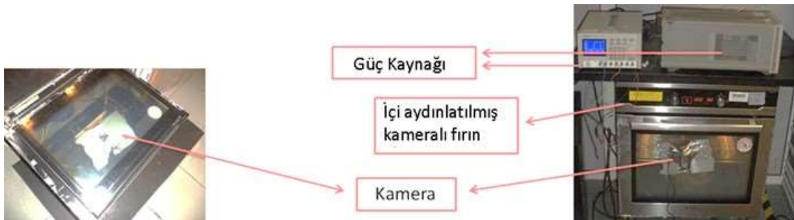
Şekil 4. 34 Yükseklik takibi için fırın kapağına kamera yerleştirilmiş deney düzeneği
