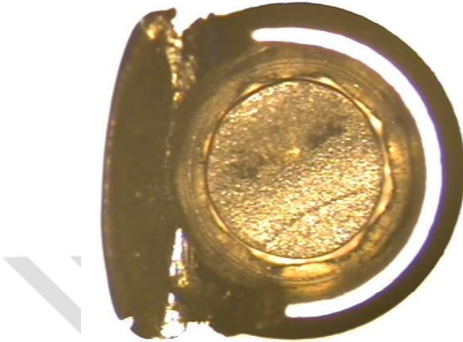
Şekil 4.3. İmplant ve Vida Kırığı Örneği
