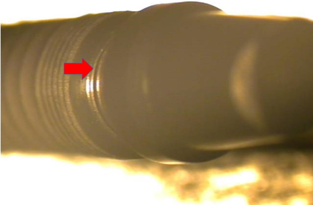
Şekil 4.2. Baskı Tarafında Açılma Örneği
