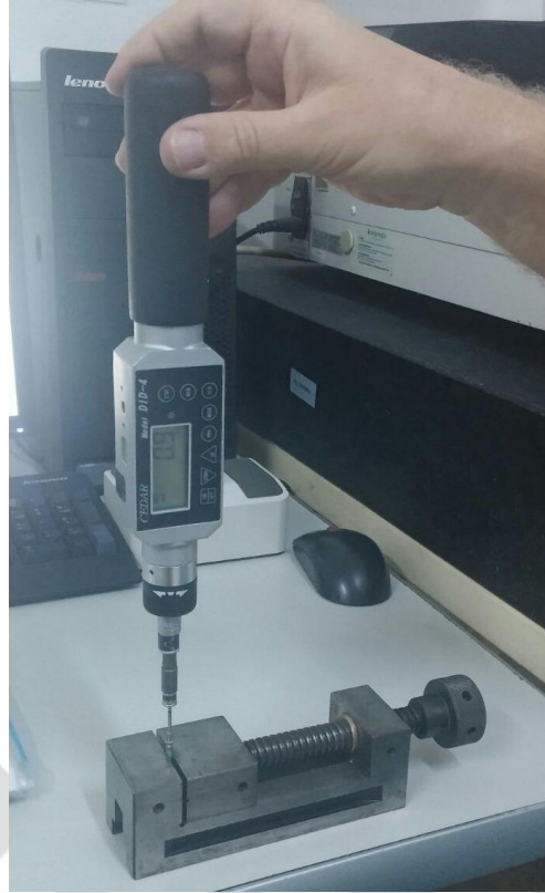
Şekil 3.10. Torque Tester ile Gevşeme Torkunun Ölçülmesi Deney Düzeneği
