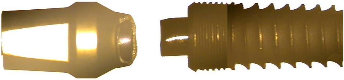
Şekil 4.1. Dayanak Kırığı Örneği
