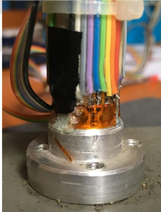
Şekil 2.23. Gerinim Ölçerlerin Eğilme ve Burulma Momenti Ölçümü için Bağlanması
