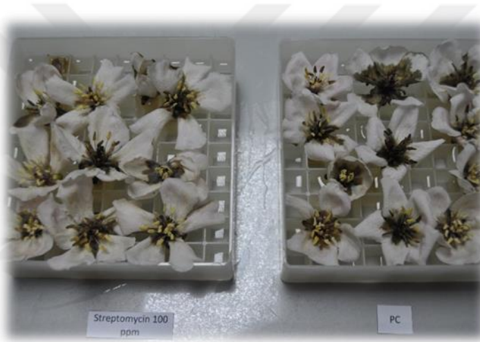
Şekil 4.8 Referans kimyasal olan streptomisin uygulamasının koparılmış çiçek testinde Ea 'ya etkisi
