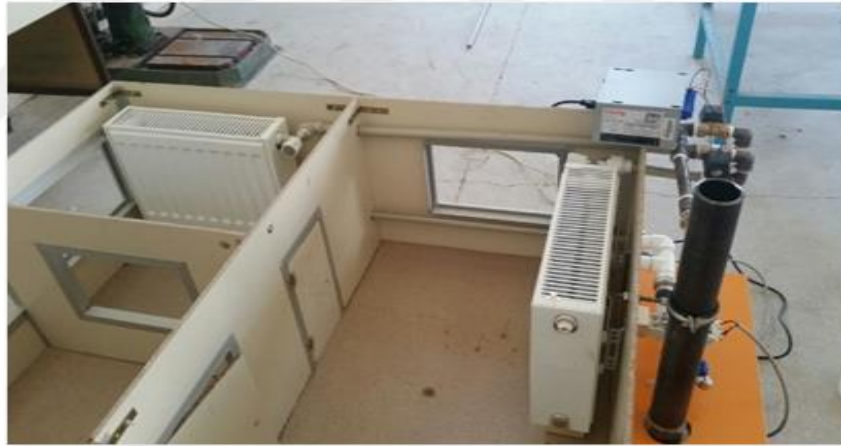
Şekil 4.4. Evin kalorifer tesisatı.
