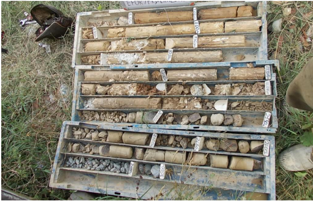
Şekil 4. 73 A16 Memba Alanındaki 11-Nolu Gözlem Kuyusu'na Ait Sondaj Resimleri (Sondaj No.7)
