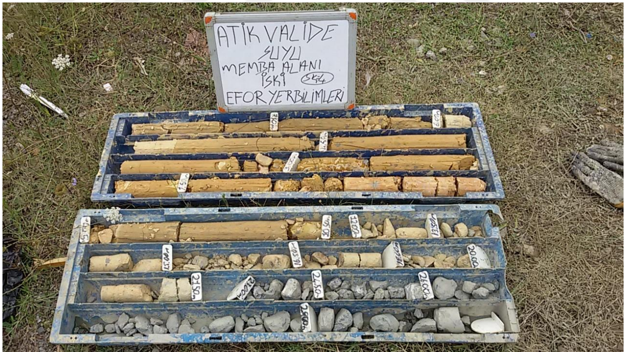
Şekil 4. 30 A5 Memba Alanındaki 7 ve 9-Nolu Gözlem Kuyularına ait Sondaj Resimleri (Sondaj No 3 ve 4)
