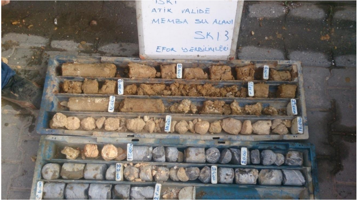
Şekil 4. 12 A3 Memba Alanındaki 1-Nolu Gözlem Kuyusu'na Ait Sondaj Resimleri (Sondaj No 18)
