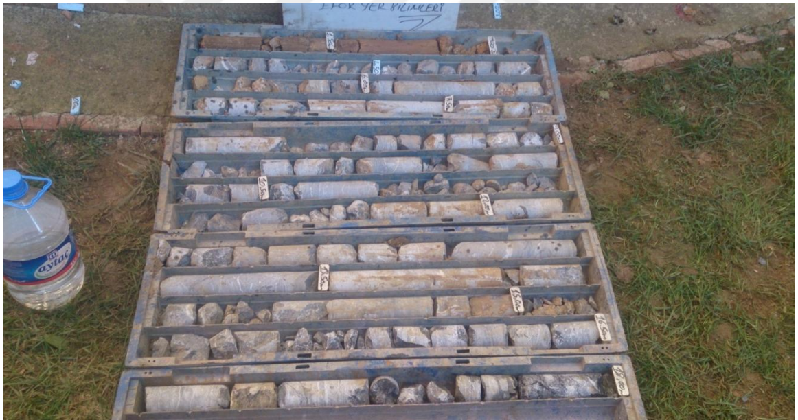
Şekil 4. 59 A13 Memba Alanındaki 14-Nolu Gözlem Kuyusu'na Ait Sondaj Resimleri (Sondaj No 16)
