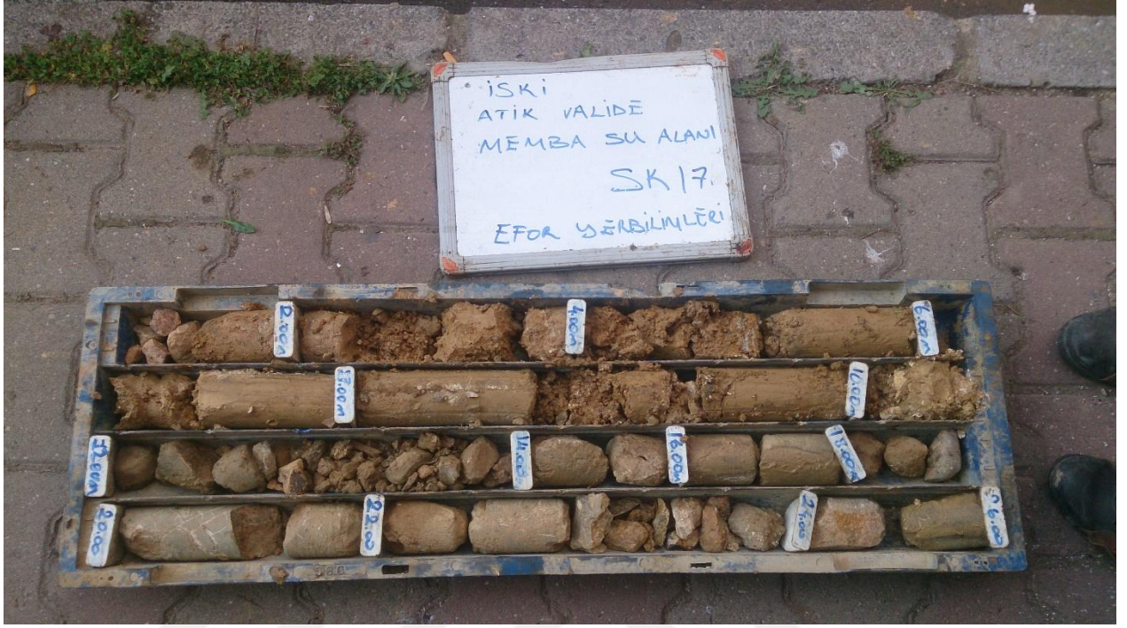
Şekil 4. 5 A1 Memba Alanındaki 3-Nolu Gözlem Kuyusu'na Ait Sondaj Resimleri (Sondaj No.17)
