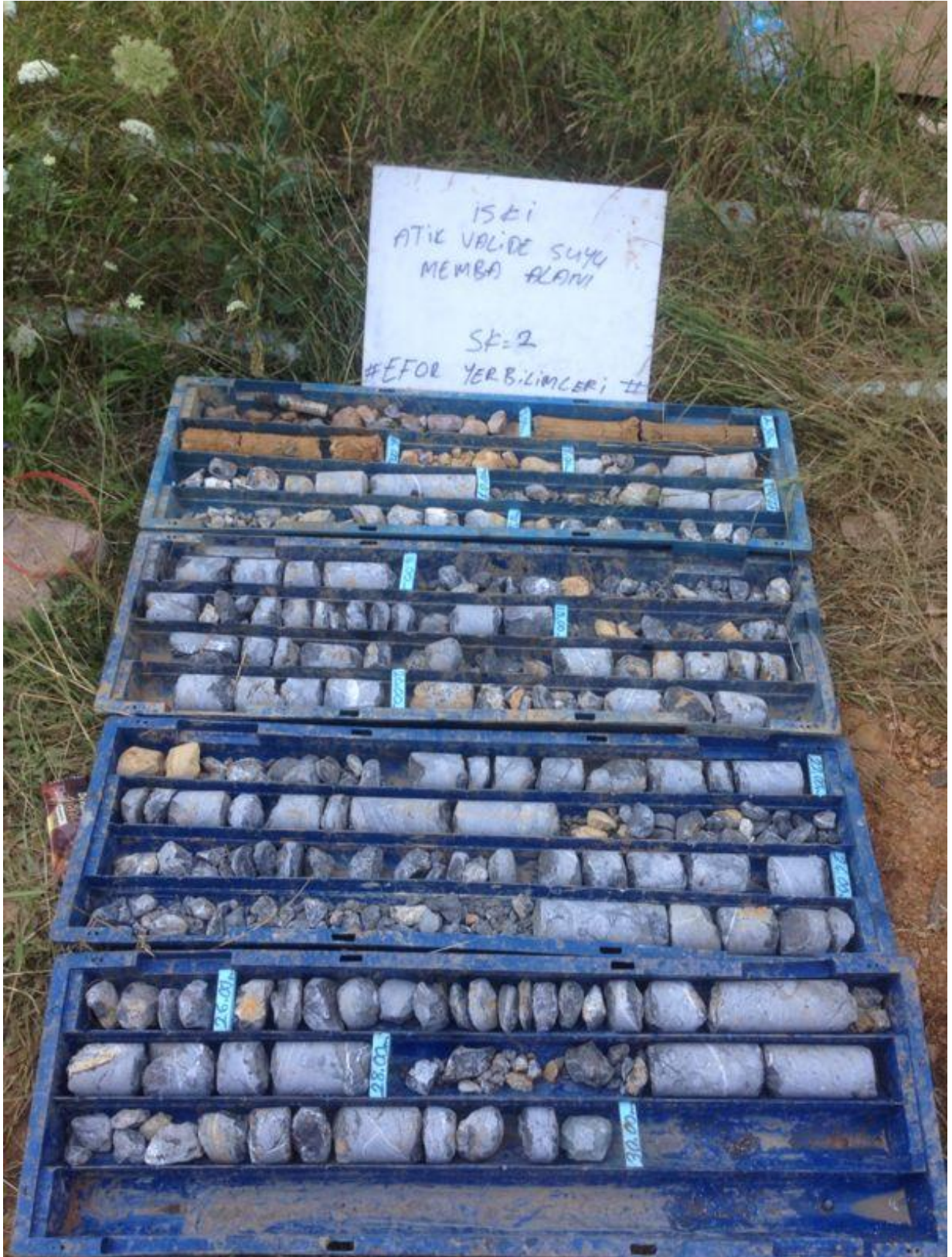
Şekil 4. 37 A6 Memba Alanındaki 5-Nolu Gözlem Kuyusuna Ait Sondaj Resmi
