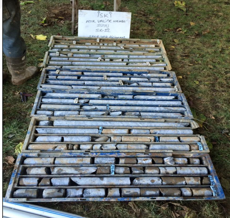
Şekil 4. 42 A8 Memba Alanındaki 19-Nolu Gözlem Kuyusu'na Ait Sondaj Resimleri
