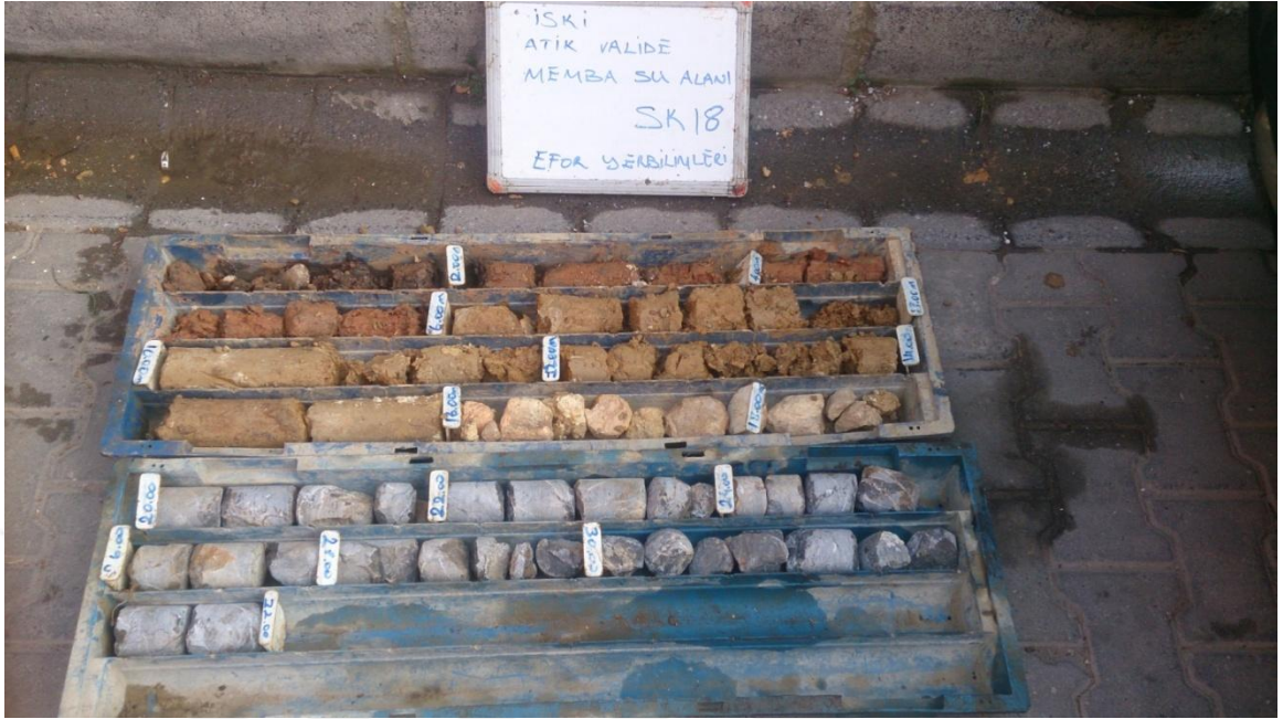
Şekil 4. 18 A4 Memba Alanındaki 4-Nolu Gözlem Kuyusu'na Ait Sondaj Resimleri
