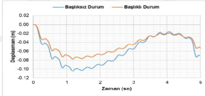
Şekil 4.33. Hardening Soil zemin modeli ve sıkı kum zemin koşulları
