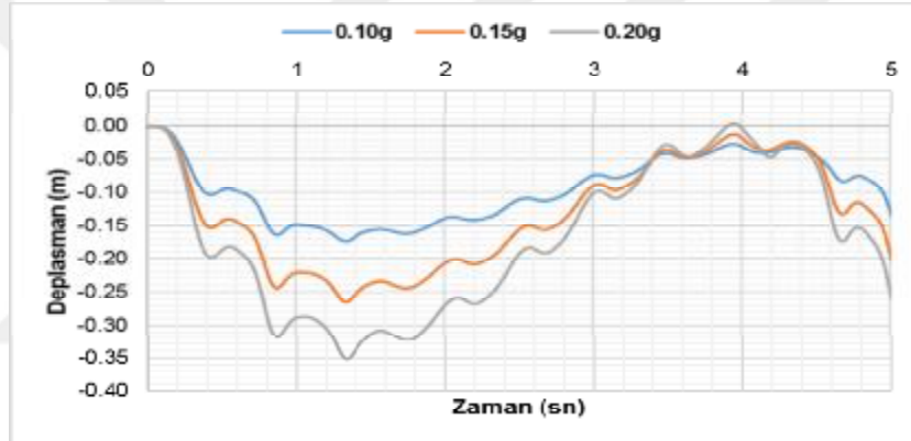
Şekil 4.18. Gevşek koşullar için kazık başındaki deplasman-zaman grafiği-(HS)
