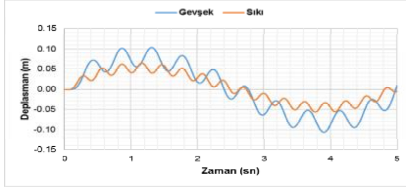
Şekil 4.9. Zemin yüzeyinde elde edilen deplasman-zaman grafiği-(HS)
