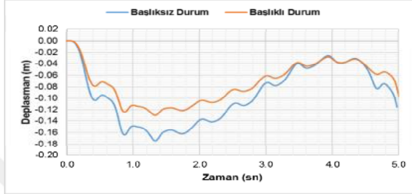
Şekil 4.32. Hardening Soil zemin modeli ve gevşek kum zemin koşulları
