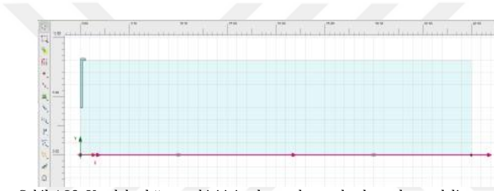
Şekil 4.29. Kazık başlığının etkisi için oluşturulan sonlu elemanlar modeli
