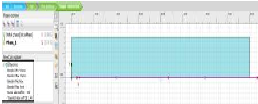
Şekil 4.5. Sonlu elemanlar modeli ve viskoz sınırlar (sönümleyici sınırlar)
