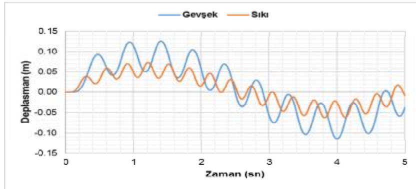
Şekil 4.7. Zemin yüzeyinde elde edilen deplasman-zaman grafiği-(MC)
