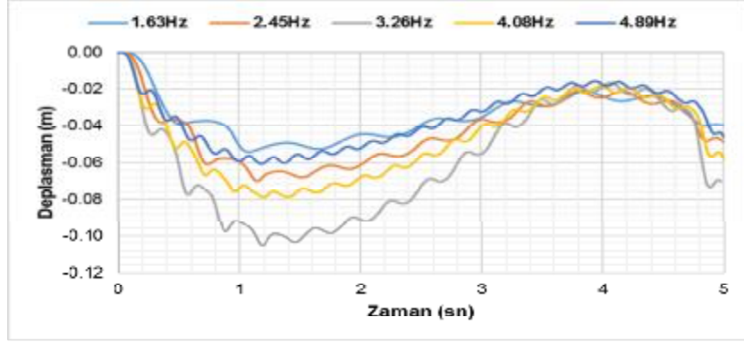
Şekil 4.27. Sıkı koşullarda farklı frekanslar için düşey deplasmanlar–(HS)
