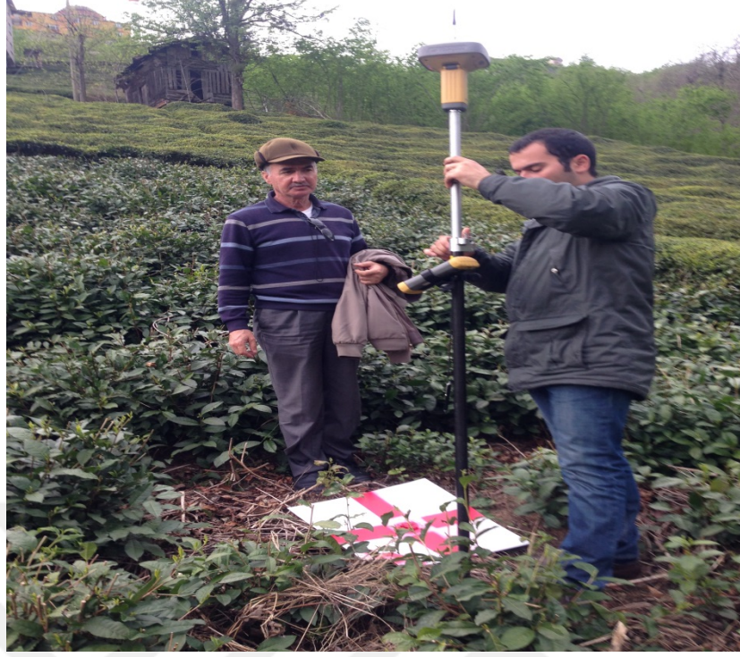
Şekil 4.7: Yer Kontrol Noktasının Koordinat değerlerinin CORS/RTK İle Belirlenmesi.
