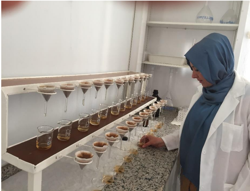
Şekil 3.8. Laboratuvarda toprakta fosfor analizlerinin yapılması
