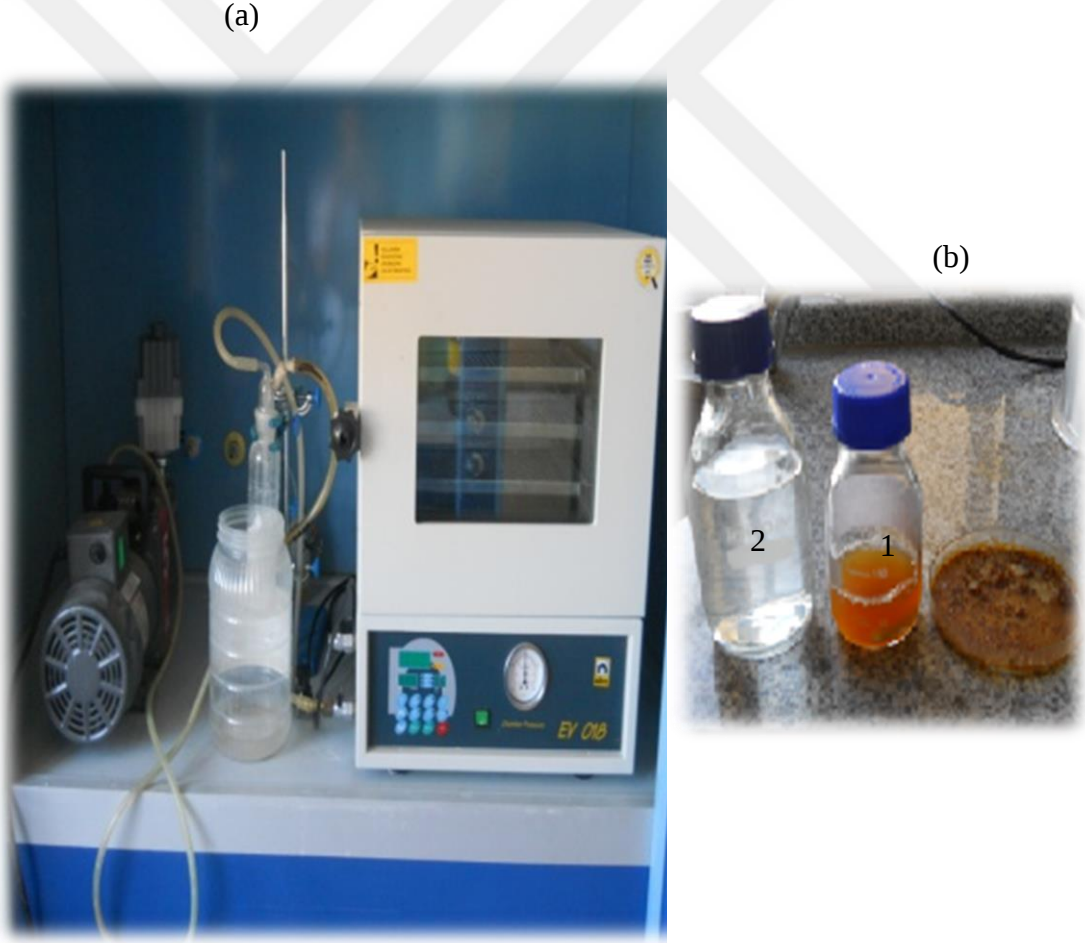
Şekil 3.6. (a) E.elaterium meyve suyunun kurutulduğu vakumlu fırın (b) kurutulan meyve suyu ve kalıntısı
