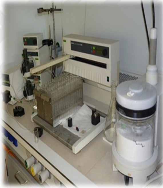
Şekil 3.13. E.elaterium kloroform ekstraktının flaş kromatografisinde fraksiyonlanması
