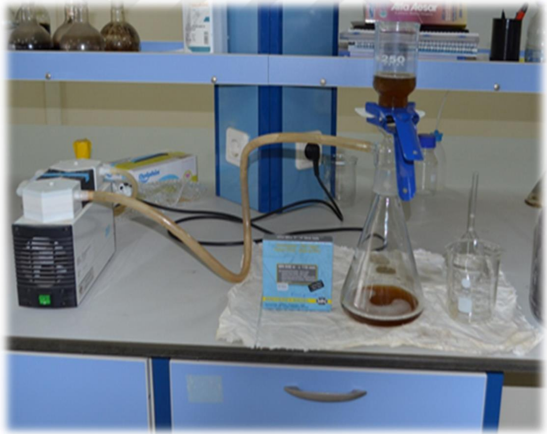
Şekil 3.5. E.elaterium meyve suyunun vakum düzeneği ile süzülmesi
