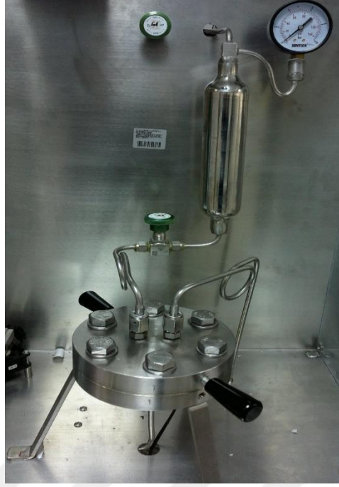
Şekil 3.4: Gaz geçirgenlik sistemi görüntüsü.
