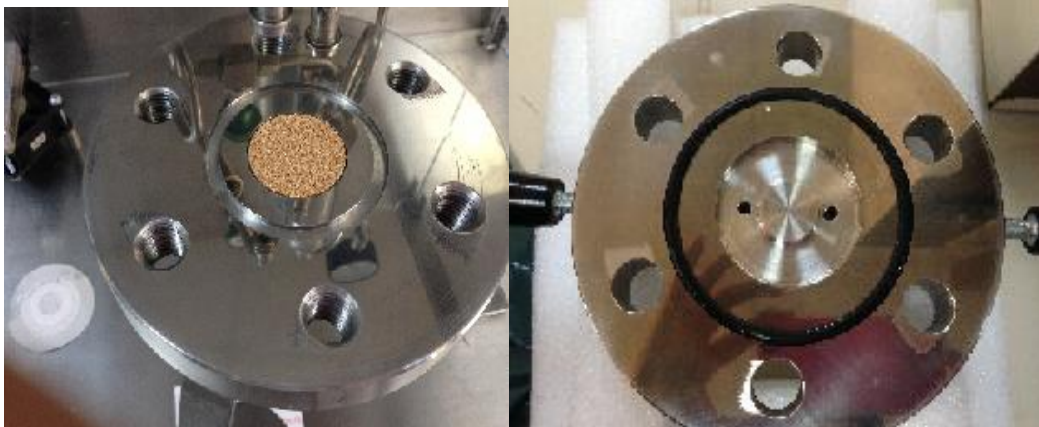
Şekil 3.3: Gaz geçirgenlik sisteminde membran test hücresi görüntüsü.
