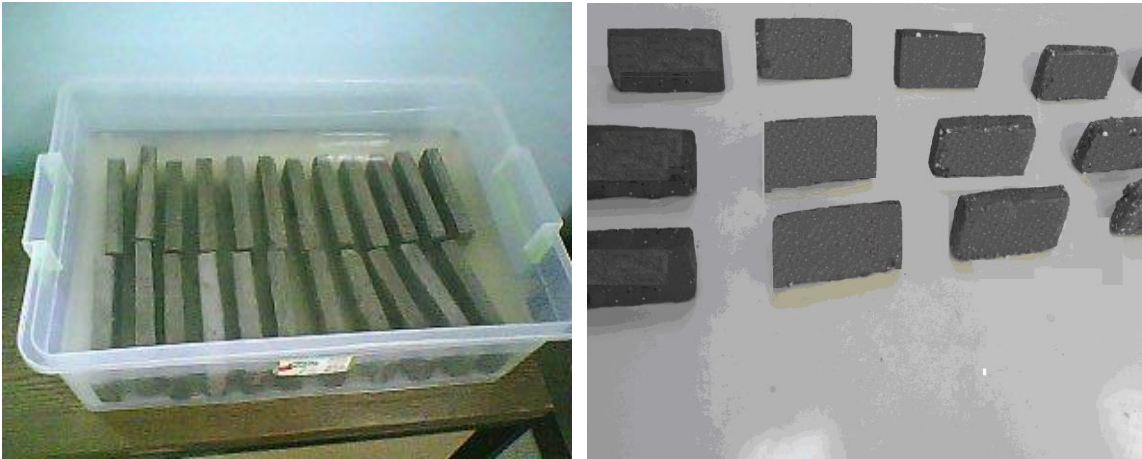
Şekil 6.8. Numunelerin su emme ve kuruma deneyinde bekletilme süreçleri
