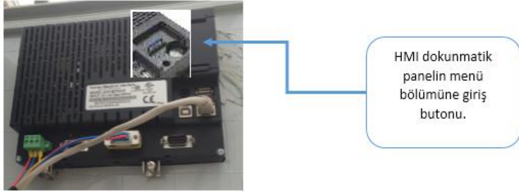
Şekil 3.54 HMI dokunmatik panelin menü butonu
