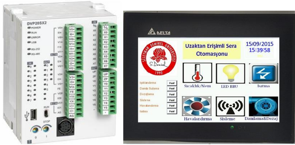
Şekil 3.30 Kontrol ünitesi ve HMI dokunmatik panel
