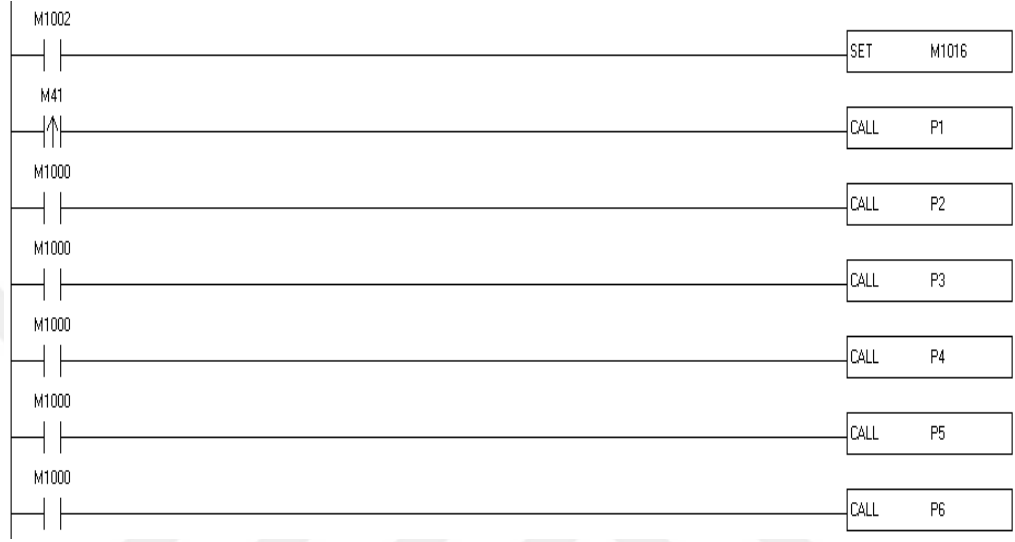
Şekil 3.70 PLC yazılım örneği
