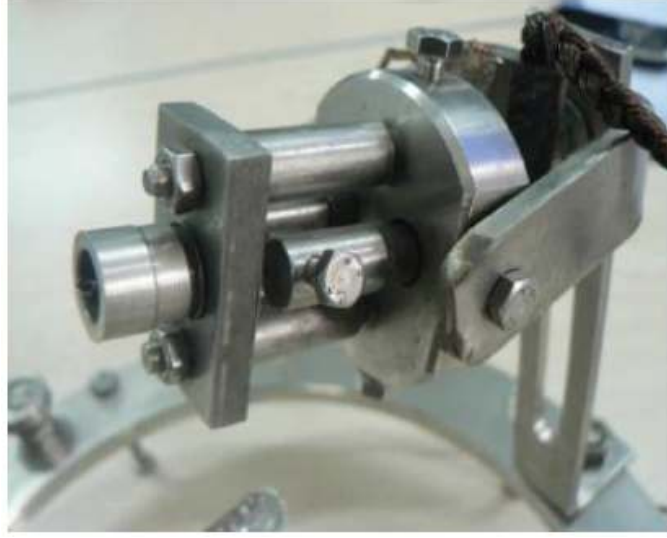
Şekil 4.7. İçinde katot filamanı bulunan elektron tabancası.
