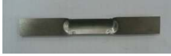
Şekil 4.5. TVA sisteminde kullanılan tungsten bir pota.
