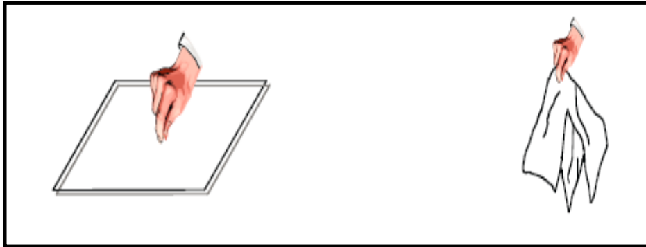
Şekil 4.9 EN 60456:2011 standardına göre yastık kılıfı ve ve leke dikilmeyen havluların katlanma şekli (BS EN 60456:2011, 2011).
