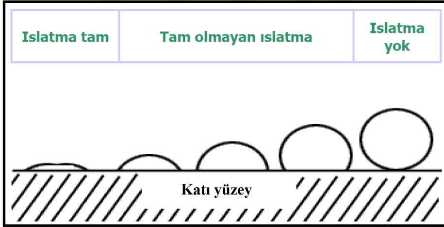
Şekil 2.12 Su damlacığının katı yüzey üzerindeki ıslatma durumları (Atıcı, 2015).
