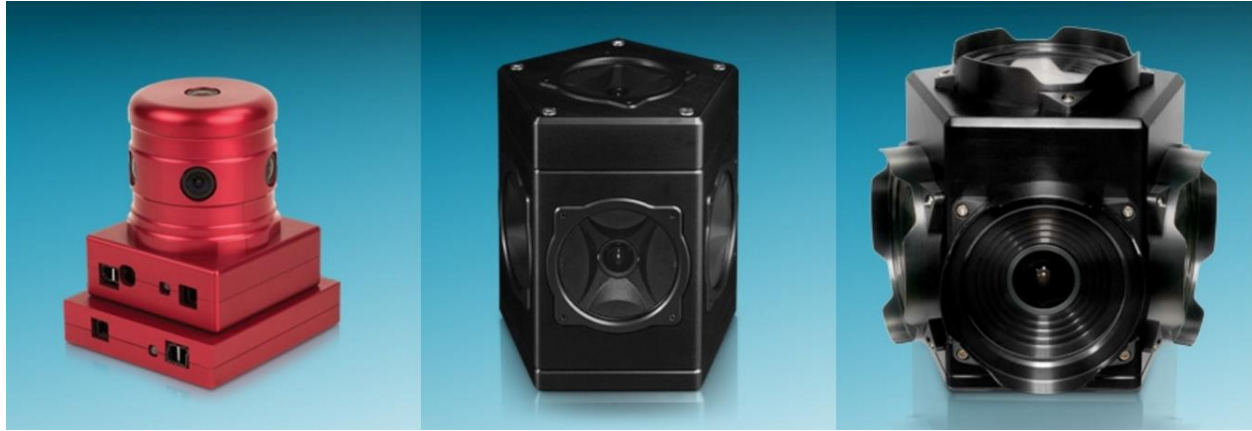
Resim 2.3. Point Grey Firmasının geliştirdiği LadyBug sensörleri a) LadyBug2 b) LadyBug3 c) LadyBug5 [25]
