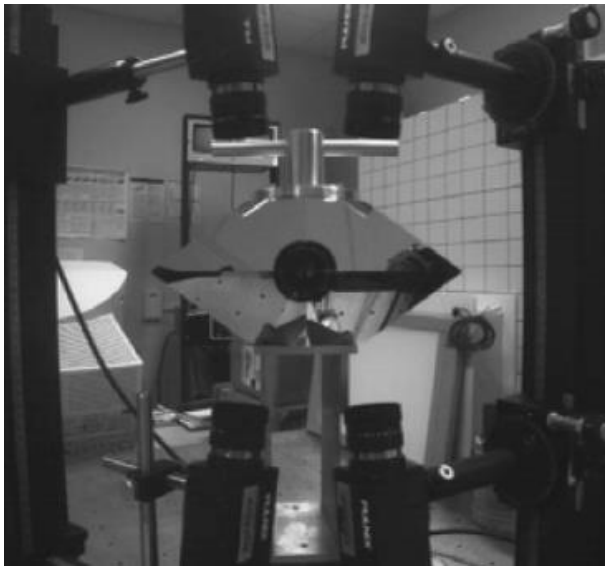
Resim 2.17. Uha ve Tan tarafından geliştirilen sensörün [39,41] 4 kameralı konfigürasyonu [40]
