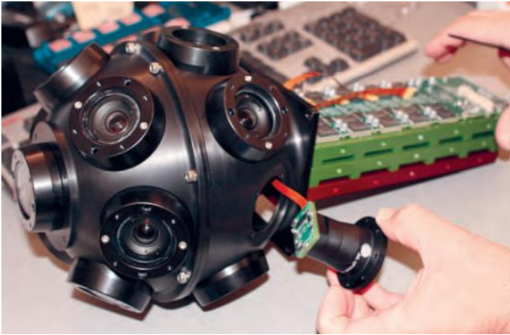
Resim 2.4. Google şirketinin geliştirdiği R7 Street View adlı kamera sistemi [86]
