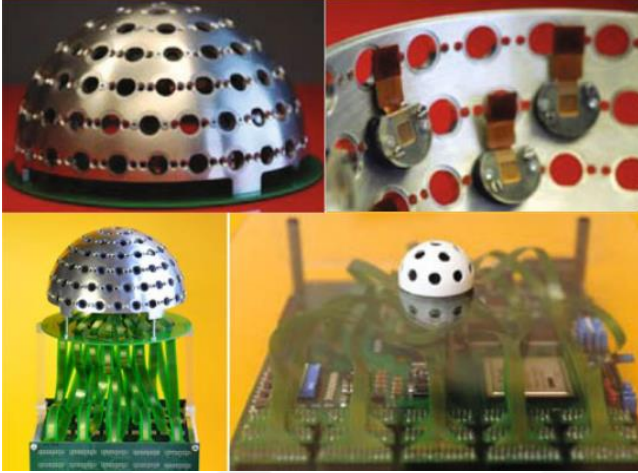
Resim.2.10. Panoptic Kamera a) üzerine kameraların yerleştirildiği küresel yüzey b) kameraların küresel yüzeyin iç tarafına yerleştirilmesi c) 30 kameradan oluşan 13 cm çaplı test prototipi d) 15 kameradan oluşan 3 cm çaplı test prototipi. [15]
