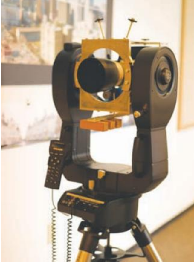
Resim 4.1. Gigapiksel çözünürlükte resim çekmek için geliştirilen PTZ kamera [68]
