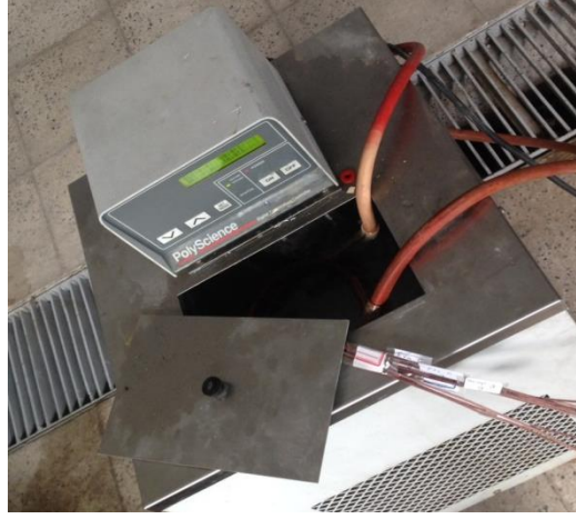
Şekil 3.9. Su havuzu makinasıyla termokupllarin kalibrasyonu
