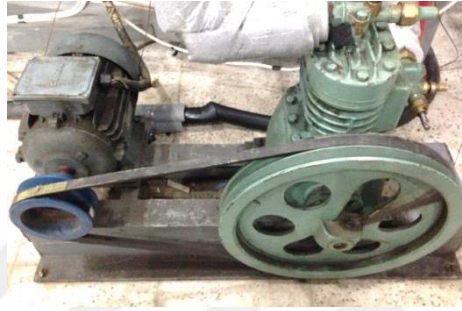
Şekil 3.4. Kullanılan açık tip pistonlu kompresörün resmi
