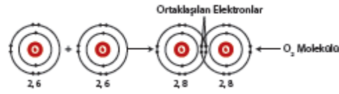
Şekil 3.7. Oksijen atomlarında ve O_2 molekülünde elektron dizilimleri.
