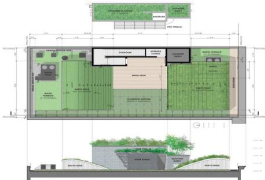
Şekil 3.23 ASLA Binası yeşil çatı planı ve kesiti [23]
