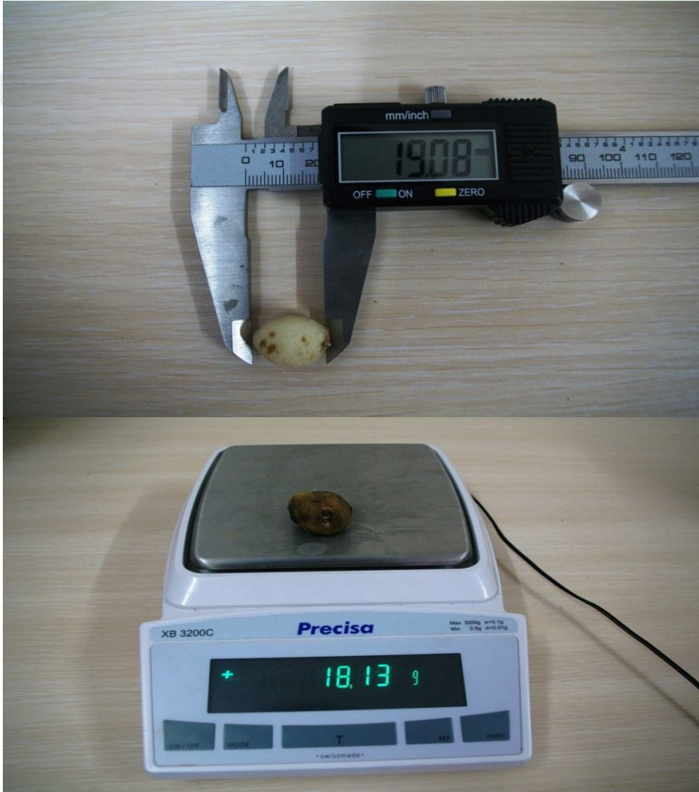
Şekil 3.6.Dijital çap ölçer ve terazi ile ölçüm
