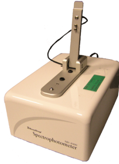
Şekil 3.9. DNA kalite ve kantitesinin belirlenmesinde kullanılan spektrofotometre (nanodrop)
