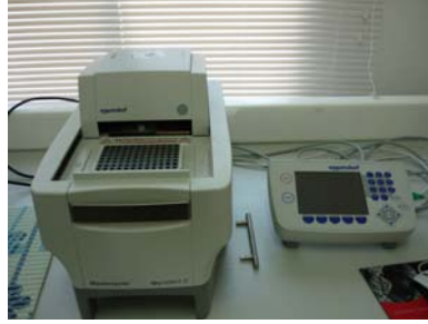
Şekil 3.10. AFLP analizlerinde kullanılan Thermal cyclers cihazı (ep gradient S)
