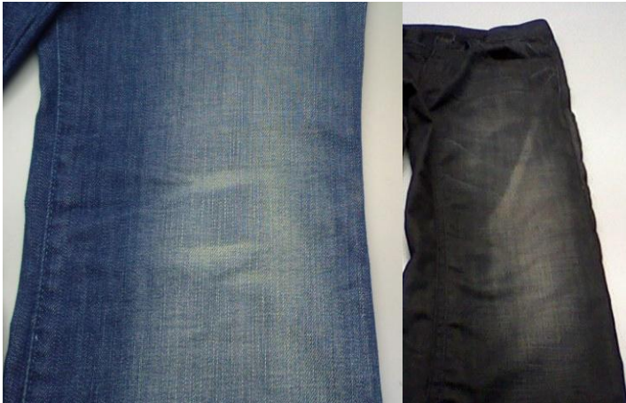
Şekil 6.7 Denim Pantolonun paçasının içe dönmesinden dolayı oluşan mekanik kırık(sol) ve Kumaşın katlanması sonucu oluşan kimyasal kırık(sağ)
