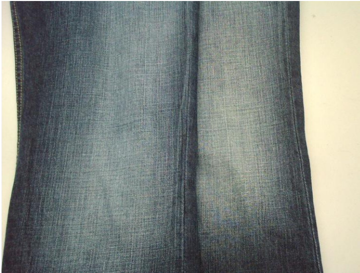
Şekil 6.4 Ozon işlemi sonrası sararma (Sol-ozon öncesi, sağ-ozondan dolayı sararmış ürün)
