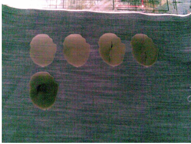
Şekil 8.2 Soldan sağa doğru 100 sn/m, 150 sn/m, 200 sn/m, 250 sn/m alt sıra 300 sn/m lazer şiddeti ile taranmış kumaş örneği
