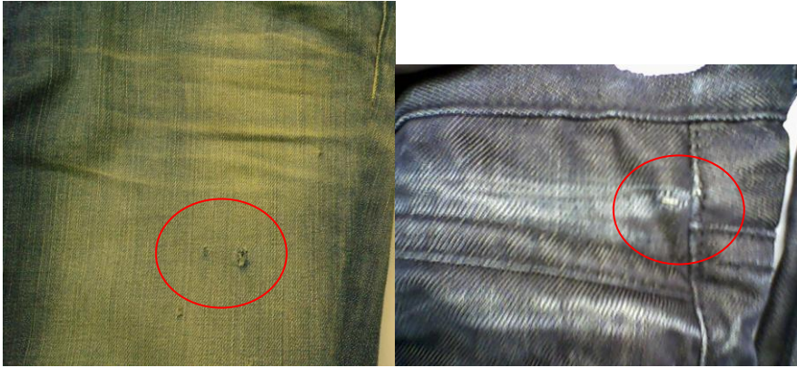
Şekil 6.8 Yapılan zımpara işleminin fazla olması nedeni ile taş yıkamada delik oluşumu (sol) ve yapılan kimyasal işlemin fazla olması nedeni ile oluşan yıpranma
