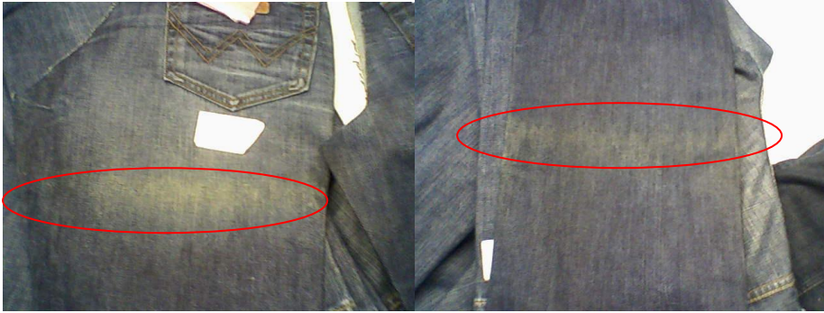
Şekil 6.5 Plastik folyo içerisinde hava ile temas eden katlama yerlerinde sararma
