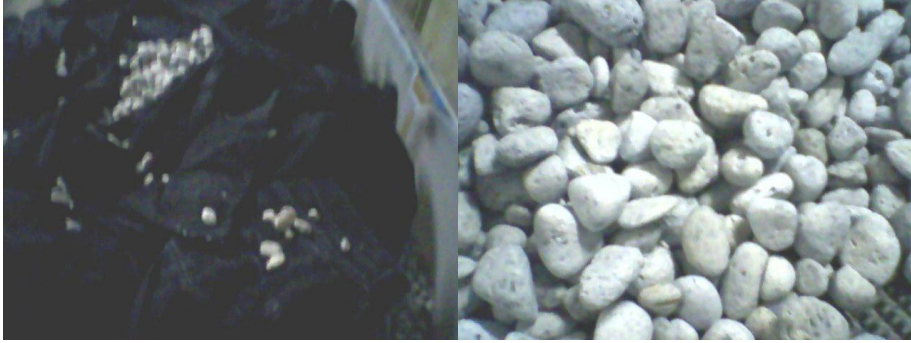
Şekil 5.1 Ponza taşı ile işlem görmekte olan denim pantolonlar (solda) ve ponza taşı
