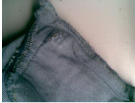
Şekil 6.10 Taş yıkama sonrası fermuarın ceplik kumaşta oluşturduğu aşınma
