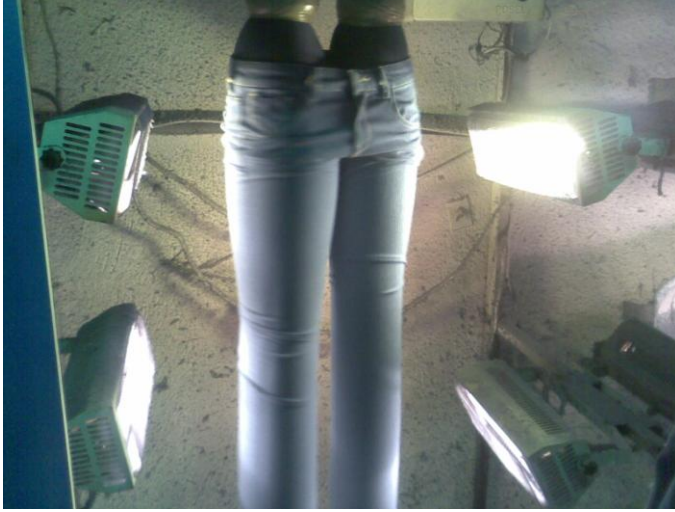
Şekil 6.12 Üç boyutlu efekt elde etmek için soba önünde istenilen şeklin fiksajı
