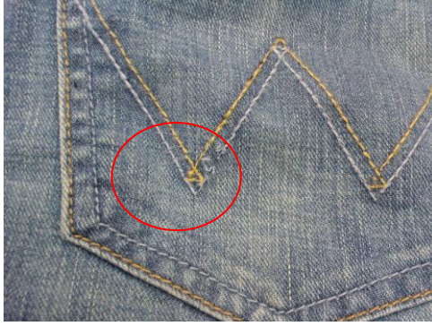
Şekil 6.9 Mekanik işlemler nedeni ile dikişlerde oluşan yıpranma ve kopuşlar
