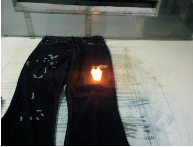
Şekil 4.1 Lazer işlemi görmekte olan bir denim pantolon
