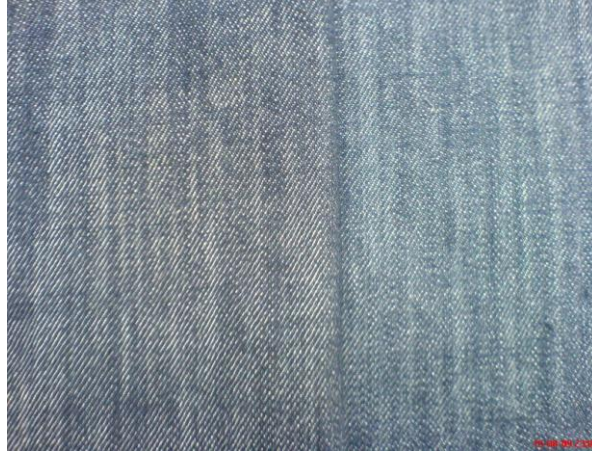
Şekil 8.3 4 bar ve 6 bar hava ile kumlama yapılmış denim kumaş
