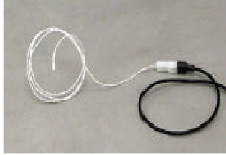
Şekil 3.4 Solunum sinyallerinin alındığı nazal termistör
