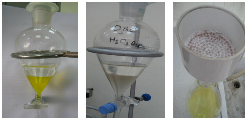
Şekil 7.22: Butexle yüklenen altın çözeltisinin okzalik asitle sıyırılması ve redüklenen altın iyonları.
