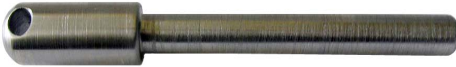
Şekil 3.10 : Tezde kullanılan emniyet vanasının oynar tabla mili.
