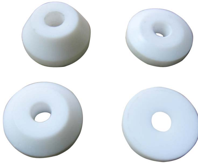
Şekil 3.5 : Tezde kullanılan emniyet vanasının PTFE kapatma elemanları.
