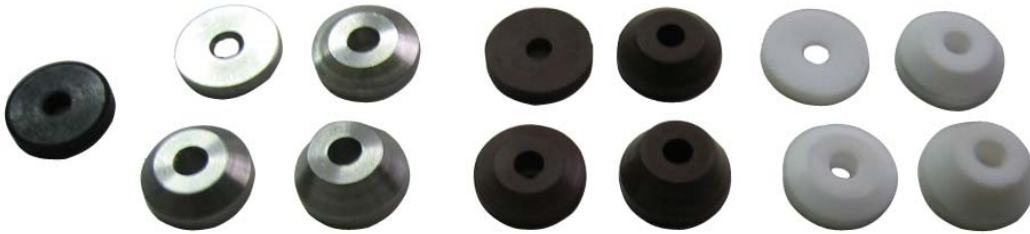
Şekil 3.4 : Tezde kullanılan emniyet vanasının kapatma elemanları.
