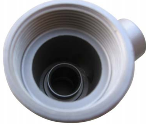
Şekil 3.2 : Tezde kullanılan emniyet vanası oturma yüzeylerinden biri.
