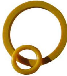
Şekil 3.37 : Tezde kullanılan emniyet vanasının o-ringleri.
