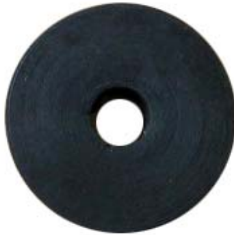
Şekil 3.7 : Tezde kullanılan emniyet vanasının EPDM kapatma elemanı.
