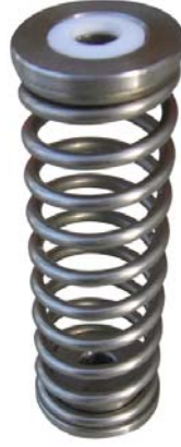
Şekil 3.46 : Yay teflonunun yatağına yerleştirilmiş hali.
