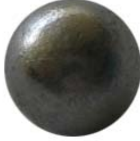
Şekil 3.34 : Tezde kullanılan emniyet vanasının bilyası.
