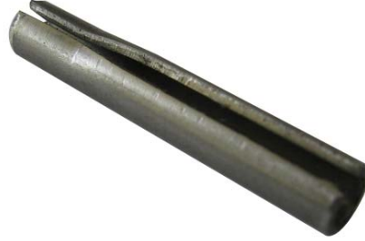
Şekil 3.35 : Tezde kullanılan emniyet vanasının pimi.
