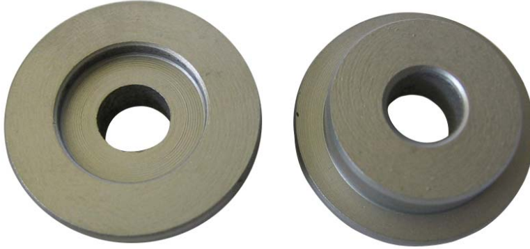
Şekil 3.27 : Tezde kullanılan emniyet vanasının yay merkezleme yatakları.
