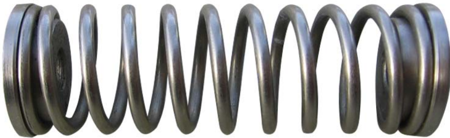
Şekil 3.45 : Yay merkezleme yataklarının yaya takılmış hali.
