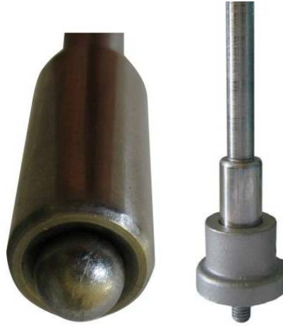
Şekil 3.41 : Bilyalı sistemde mil baęlantısı.
