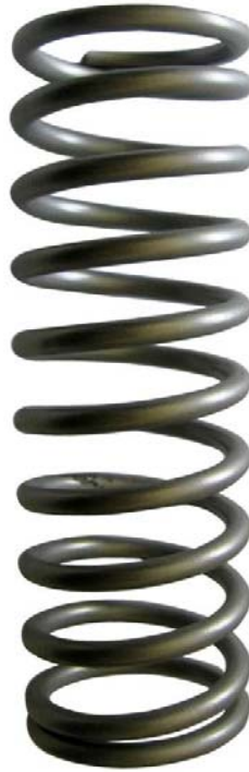
Şekil 3.12 : Tezde kullanılan emniyet vanasının yayı.
