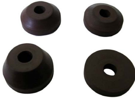
Şekil 3.6 : Tezde kullanılan emniyet vanasının FKM kapatma elemanları.
