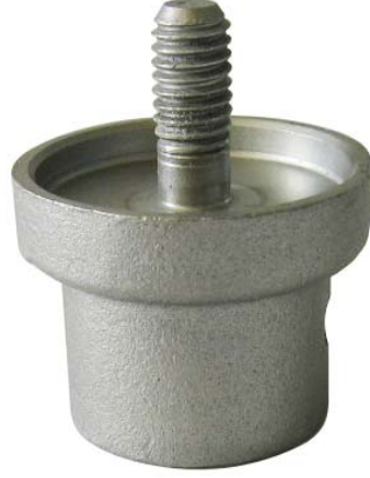
Şekil 3.9 : Tezde kullanılan emniyet vanasının tablası.
