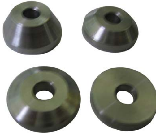
Şekil 3.8 : Tezde kullanılan emniyet vanasının AISI304 kapatma elemanları.
