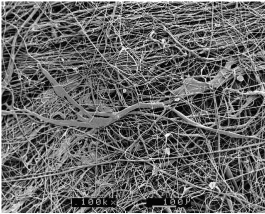
Şekil 2.19 : Elektron mikroskobu ile çekilmiş örgülü geotekstil örnekleri (Koerner, 1997)
