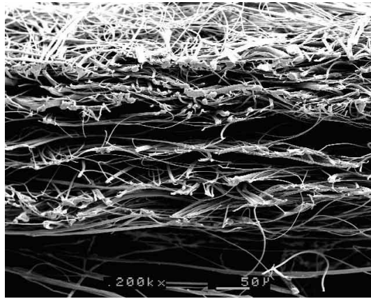
Şekil 2.19 : Elektron mikroskobu ile çekilmiş örgülü geotekstil örnekleri (Koerner, 1997)
