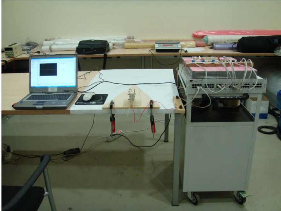
Şekil 5.13 : Dinamik gerinim ölçümü deney düzeneği.
