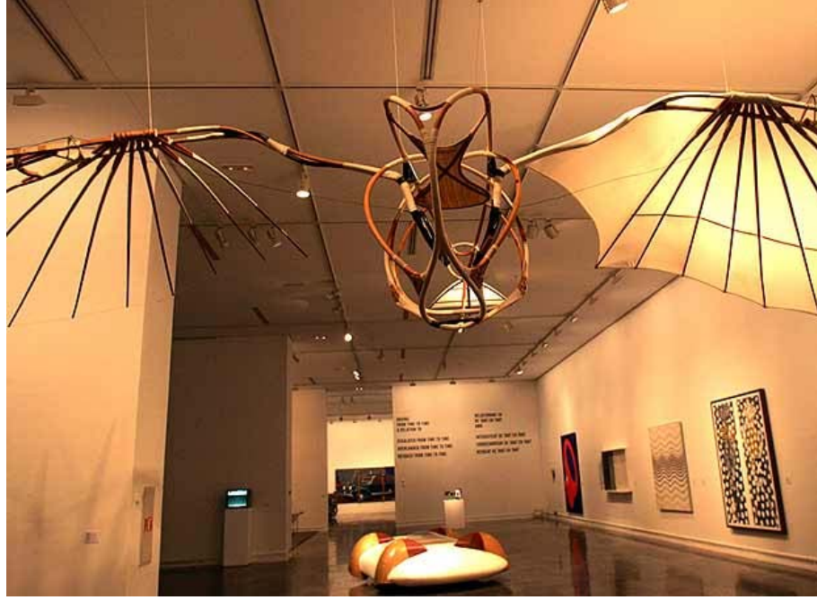
Resim:19 Tatlin, Letatlin, 1929-31, Roger Fulcher ve Chris Mc Conway tarafından yapılan rekonstrüksiyon,1969. Ahşap, İpek, Mantar , Bilye.
