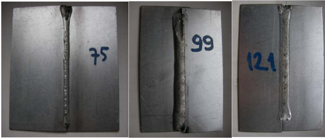
Şekil 5-2. AlZn 15 alaşımı ile lehimlenen çelik saclar
