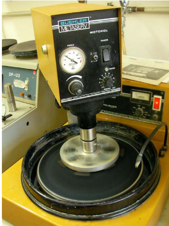
Şekil 3.3-9. Otomatik parlatma makinası işleyişi
