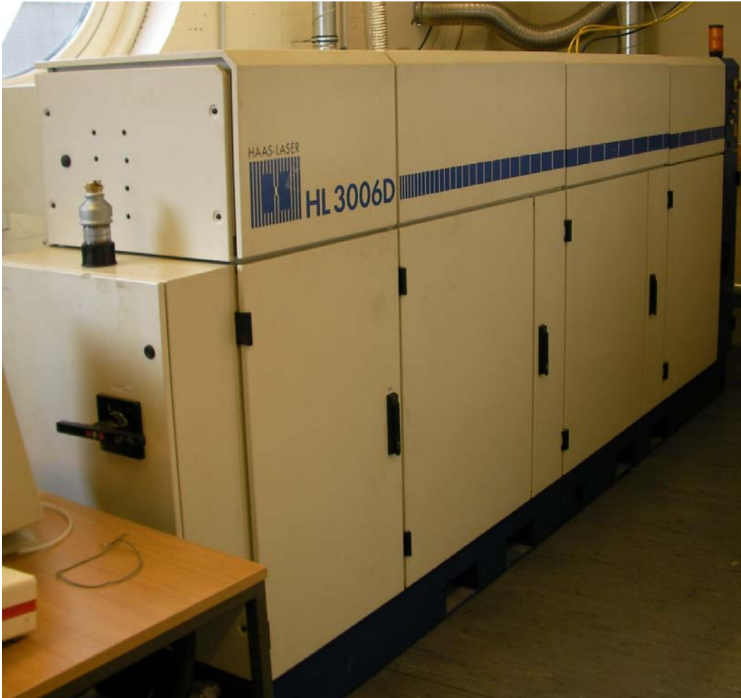
Şekil 2.2-4. Diyet pompalı solid-state lazer, Trumpf Haas HL 3006D
