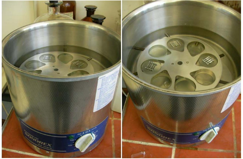
Şekil 3.3-10. Titreşimli numune temizleme makinesi
