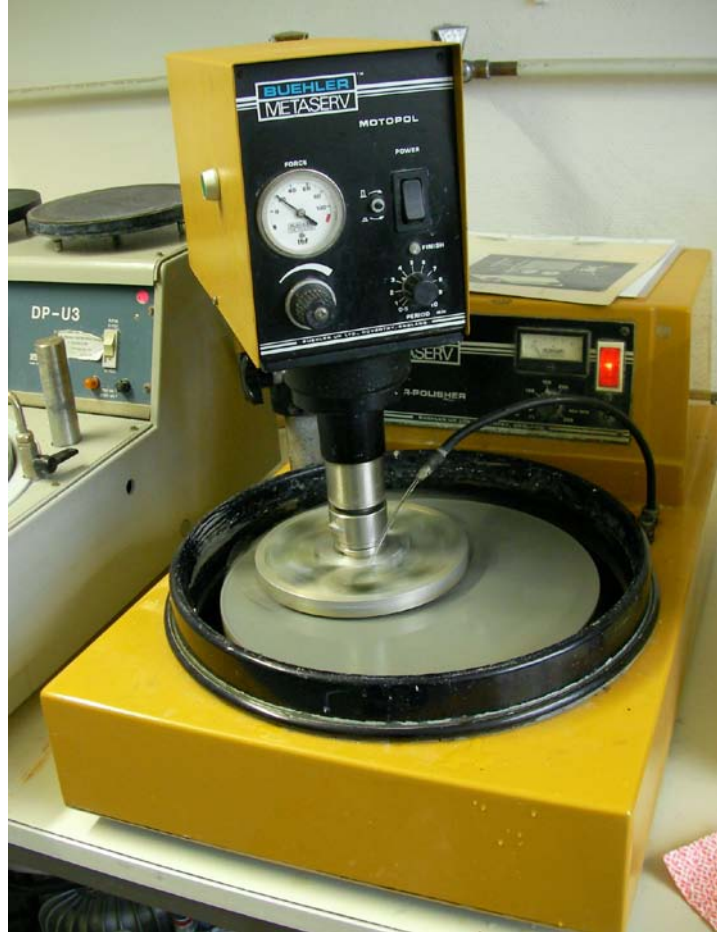
Şekil 3.3-7. Otomatik zımparalama makinası işleyişi
