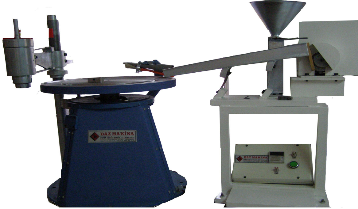
Şekil 2.36 Norveç aşınma deneyi için kullanılan cihaz.
