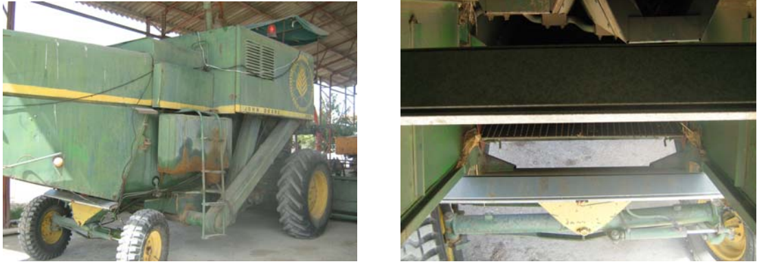
Şekil 3.20. 2008 yılı denemelerinde kullanılan biçerdöverde dane kayıp kiti parçalarının birbirleri ile kablo bağlantısının yapılmış hali.
