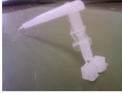
Şekil 4.47: Enjeksiyon kalıplama cihazında basılmış saf PP numune.
