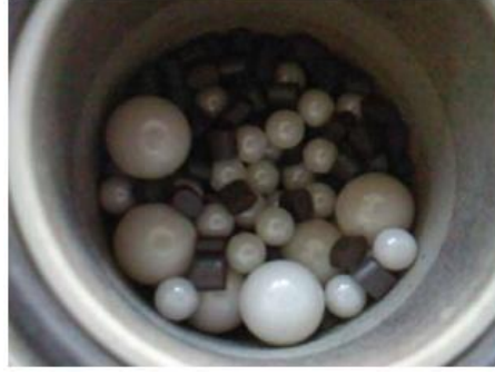
Şekil 4.35: Polimer öğütme kabında 15 dak süreli karıştırma sonrası %99PU-%1AgO sistemi.
