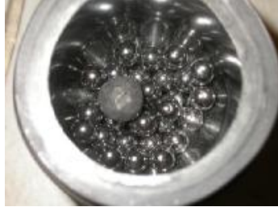
Şekil 4.29: 16 saatlik öğütme sonunda öğütülen toz ve stearik asidin kaptaki görünümü.
