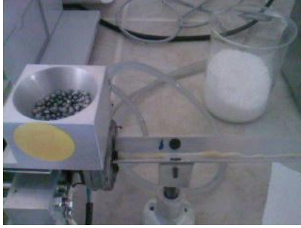
Şekil 4.43: Hazırlanan PP besleme stoğunun ekstrüderden çekilmesi.
