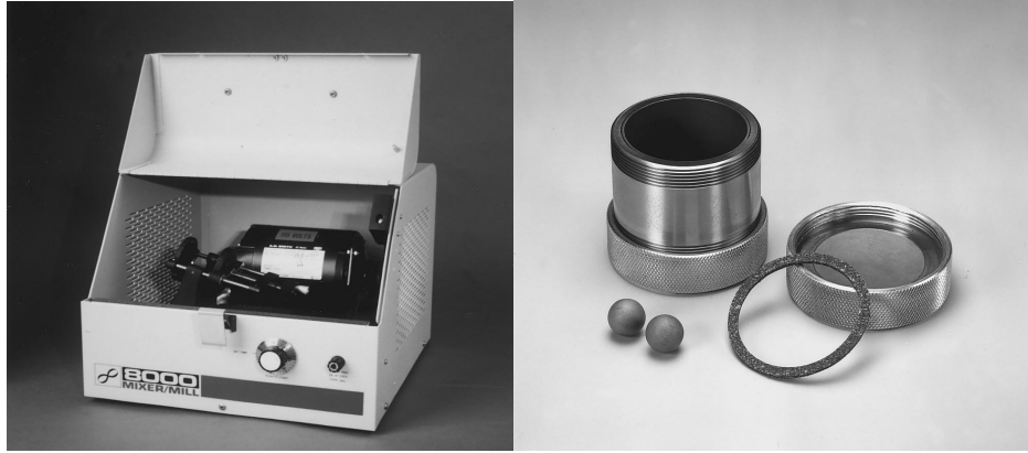
Şekil 2.4: SPEX 8000 karıştırıcı/öğütücü ve WC kap ve bilyeler (Suryaranayana, 2001).
