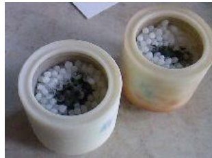
Şekil 4.38: Polimer öğütme kaplarında öğütme öncesi hazırlanmış PP-gümüş-bilye karışımı.
