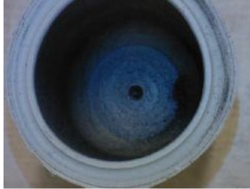
Şekil 4.40: İşlem sonrası kirlenmiş polimer kap.
