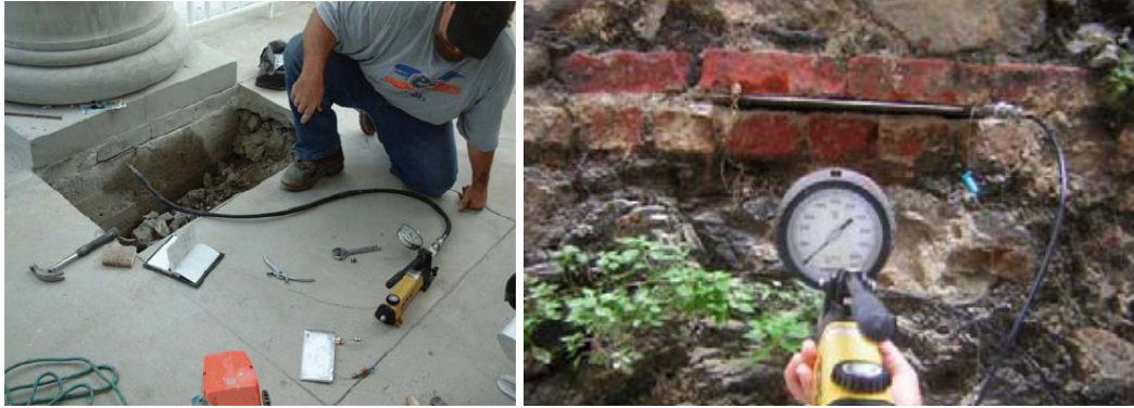
Şekil 2.14. Flat Jack Deneyi [42]
