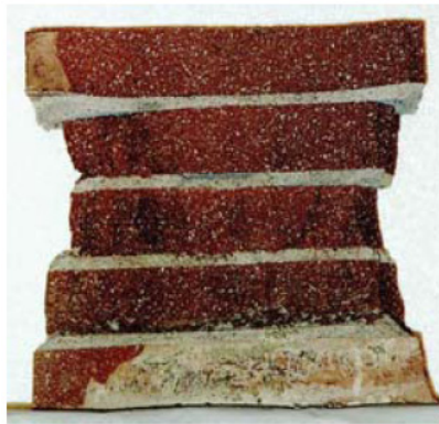
Şekil 2.9. Yığma Numune Tek Eksenli Tekrarlı Basınç Deneyi [19]
