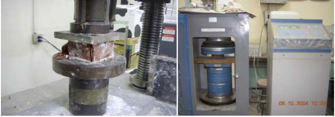
Şekil 2.16. Tek Eksenli Basınç Deneyi [42]
