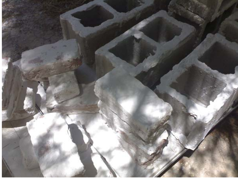
Şekil 3.2. Alçı sıvalı tuğla ve briketler
