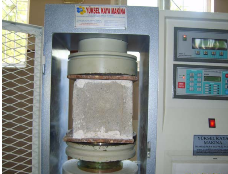
Şekil 3.9. Basınç deneyine giren briket numunesi
