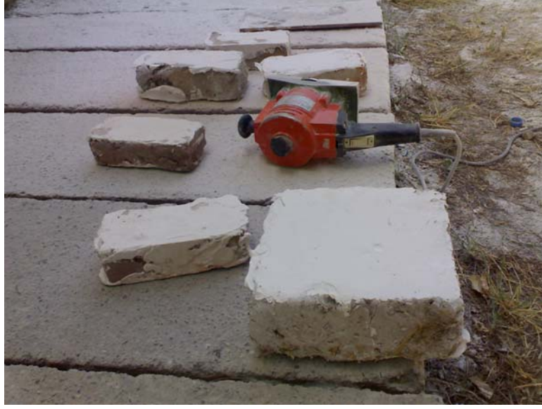
Şekil 3.3. Numunelerin yüzeylerinin traşlanması
