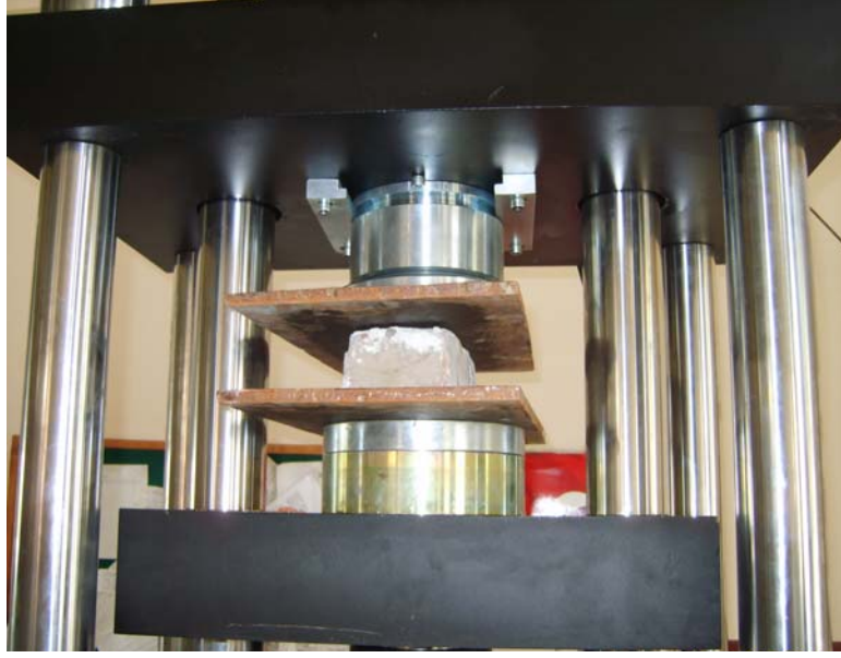
Şekil 3.8. Yükleneğinde olan bir harman tuğlası
