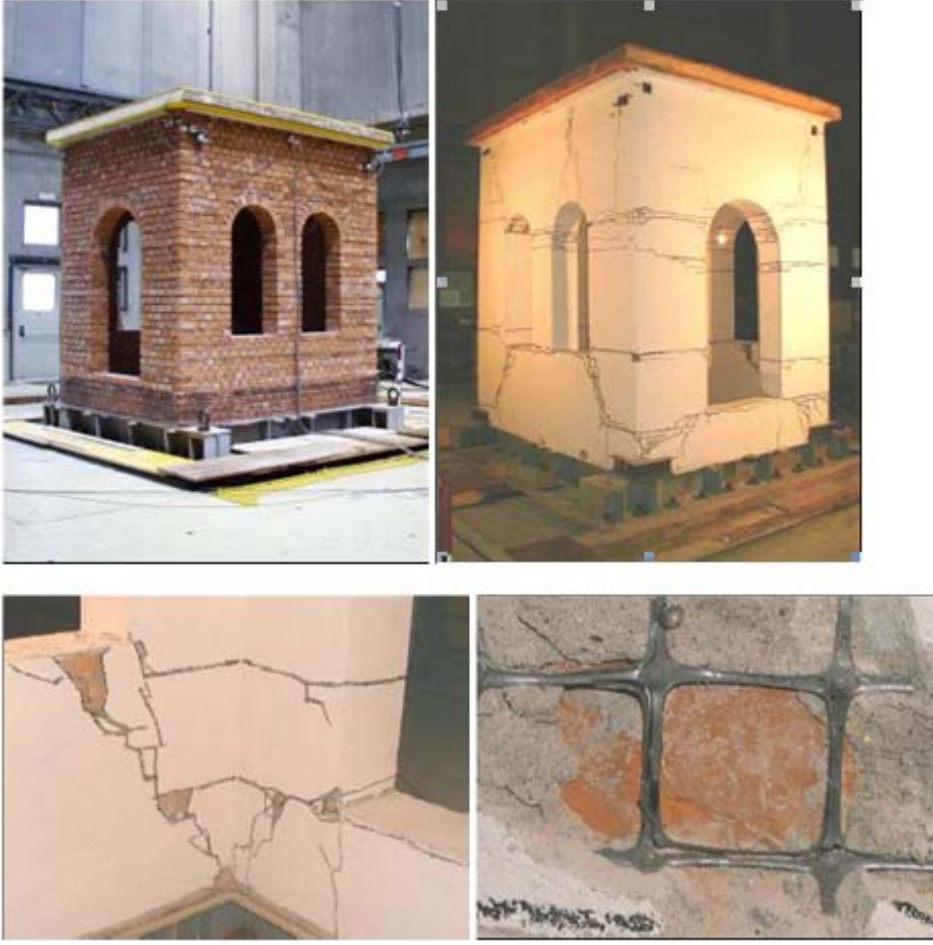
Şekil 6.3. Dolu tuğladan bir sanat yapısı modelinin polimer liflerle güçlendirilmesi deneyi öncesi ve deney sonrası (Sofronie ve diğ., 2003)
