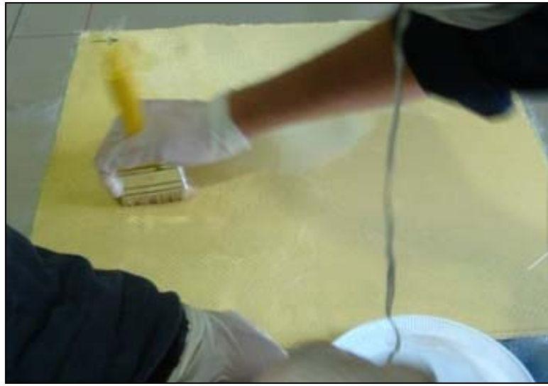
Şekil 3.8 : Fiberlerin reçine emdirilmiş fırça ile ıslatılması.
