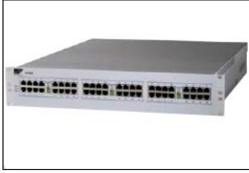
Şekil 3.2 : VXI marka EX1629 48 kanallı gerinim ölçüm cihazı [40].
