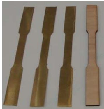
Şekil 3.17 : Hazırlanmış olan pirinç çekme deneyi numuneleri.
