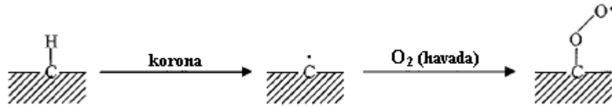
Şekil II.23 Korona İşleminin Mekanizması
