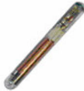
Şekil 3.8: Cam Tüp Şeklindeki Etiket [55]
