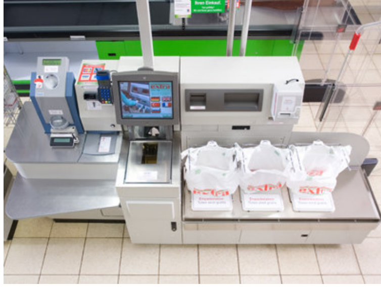
Şekil 3.20: Üzerinde RFID Okuyucusu Bulunan Kişisel Ödeme Kasası [79]
